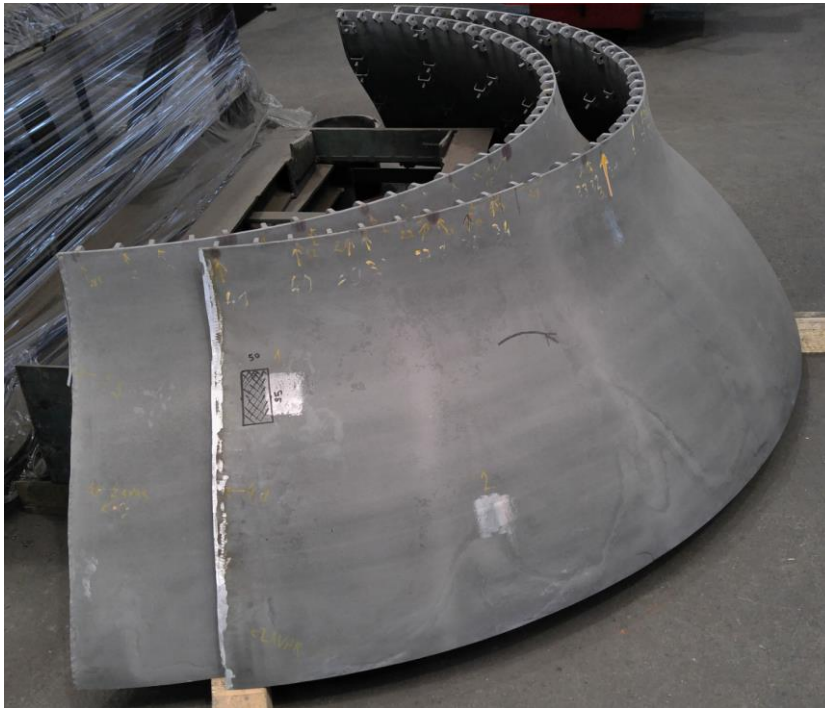
Slika 3.3 Prikaz markiranja područja za uzimanje uzorka s unutarnje oplata
