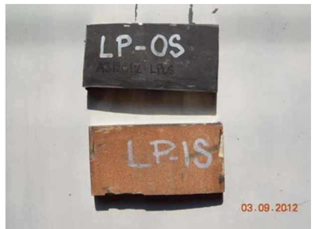
Slika 7.2 Uzorak materijala LPIS (6 x 50 x 95 mm) i LPOS (10 x 50 x 95 mm) u stvarnom stanju
