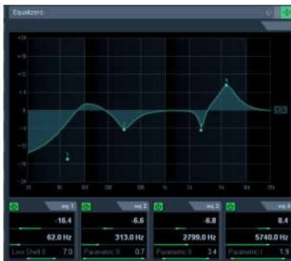
Slika 27. postavke ekvalizacije trake glavnog rifa snimanog mikrofon – pojačalo.
