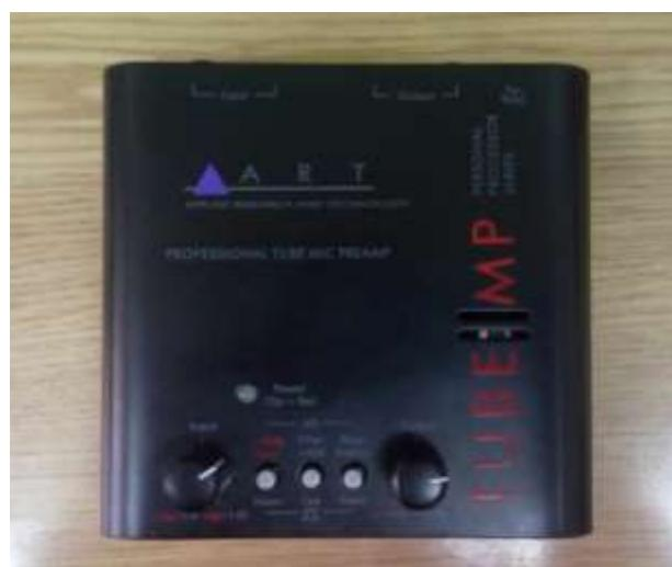
Slika 7. prepojačalo Tube AMP tvrtke ART, koje uz tranzistorski dio ima i jednu elektronsku cijev.
