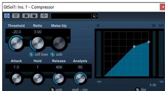
Slika 43.postavke nelinearnog obratnika kompresor za solo dionicu električne gitare.
