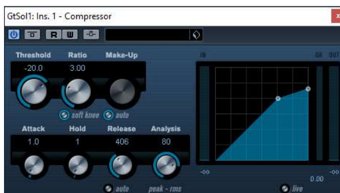
Slika 43. postavke nelinearnog obratnika kompresor za solo dionicu električne gitare.
