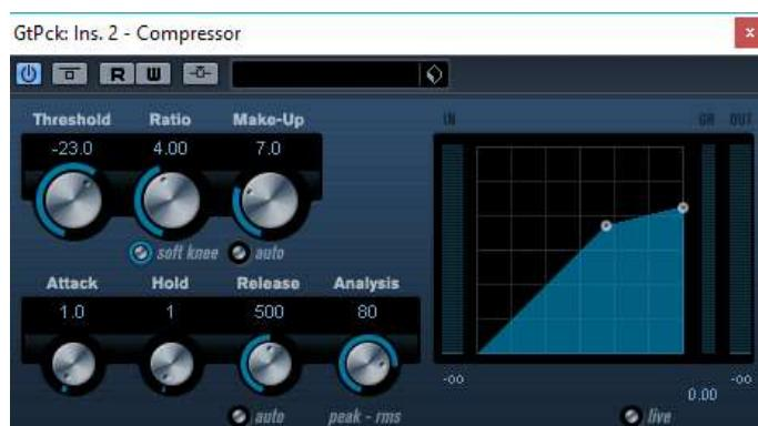
Slika 40. postavke kompresora korišten za obje audio trake pick gitare
