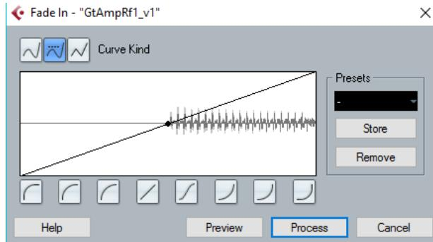
Slika 19. tvorničke postavke za podešavanje "Fade in" efekta.
