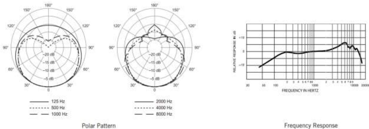
Slika 5. polaritet i frekvencijski raspon mikrofona.
