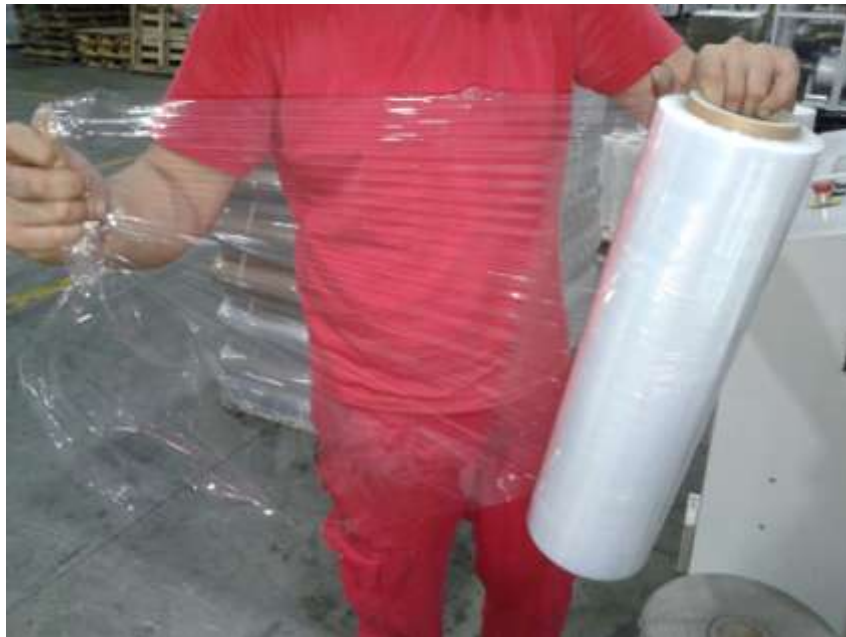
3.7 Folija dobivena ekstrudiranjem na valjak [25]
