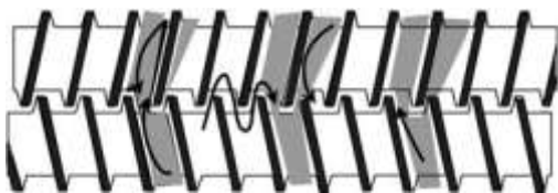
3.2 Dvopužni vijci rotiraju u suprotnom smjeru [24]
