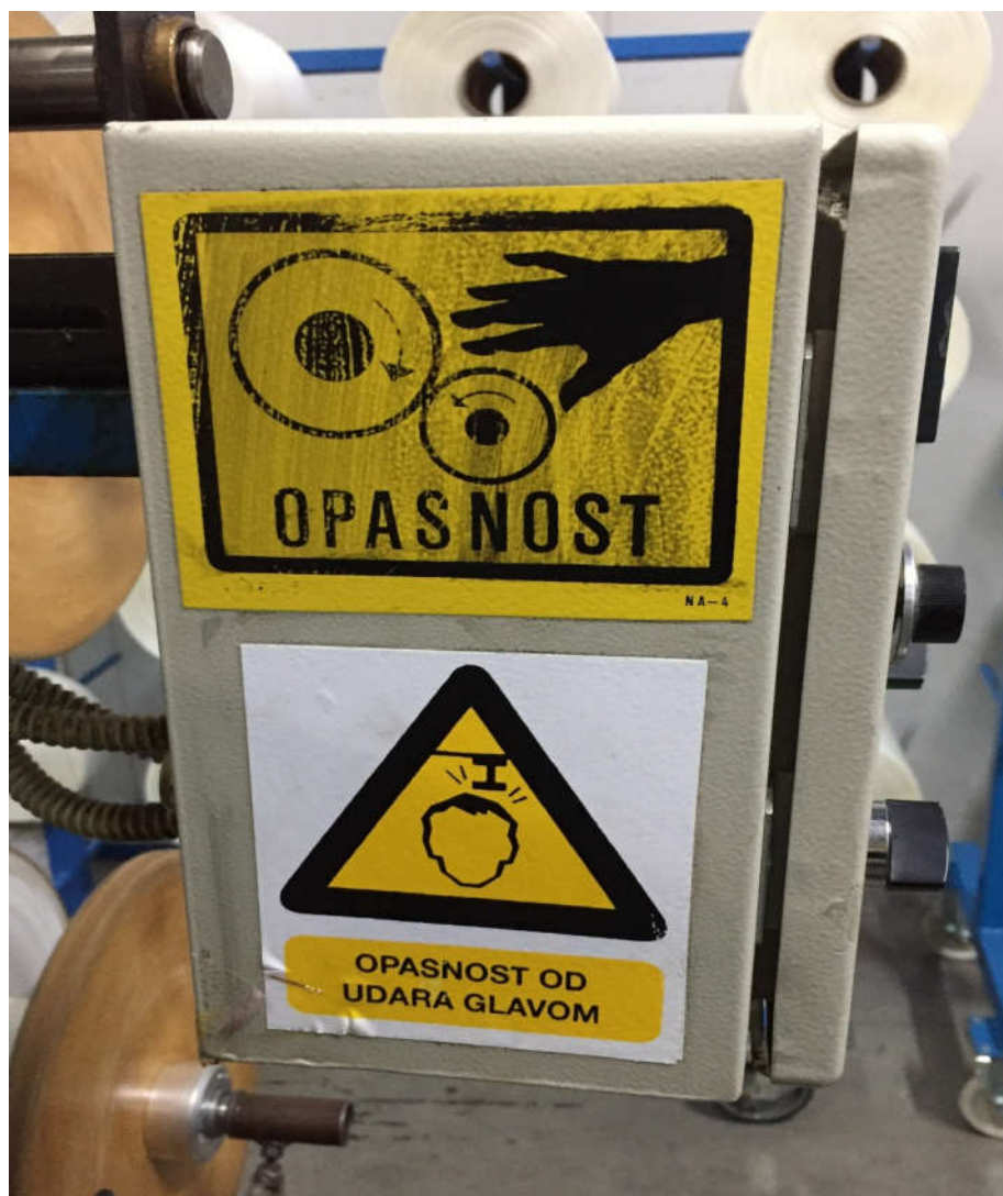
Slika 6.2 Znakovi opasnosti na radnom stroju
