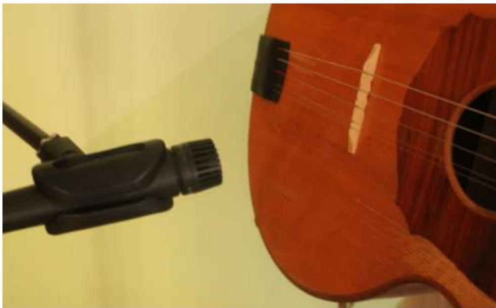
**Slika 4.9 Pozicioniranje mikrofona za brač.**
