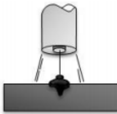
Slika 3.4. Prijenos metala kratkim spojem – shematski prikaz[6]
