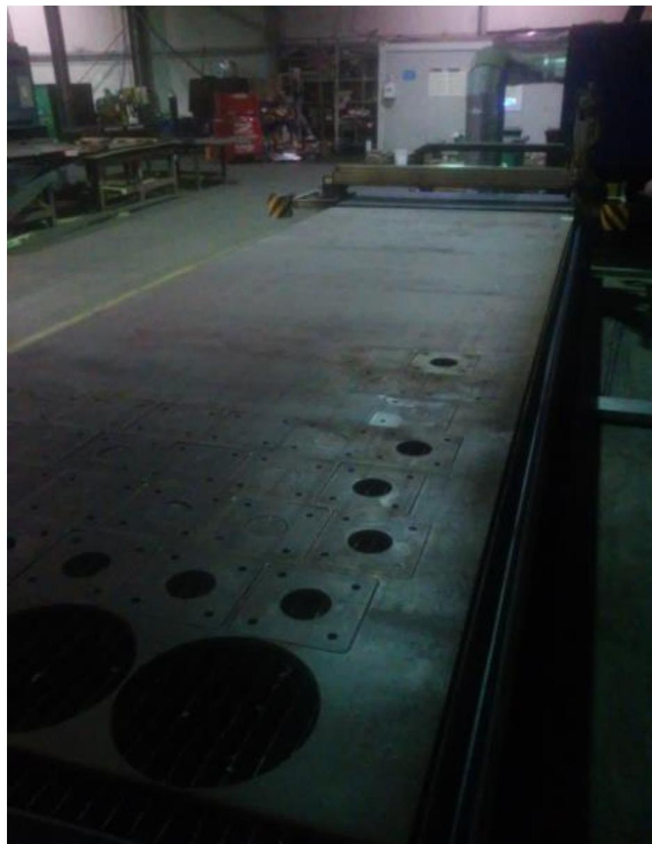
*Slika 5.7. CNC plazma rezanje temeljnih ploča*
