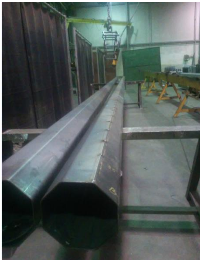
Slika 5.12. Pripajanje tijela stupa
