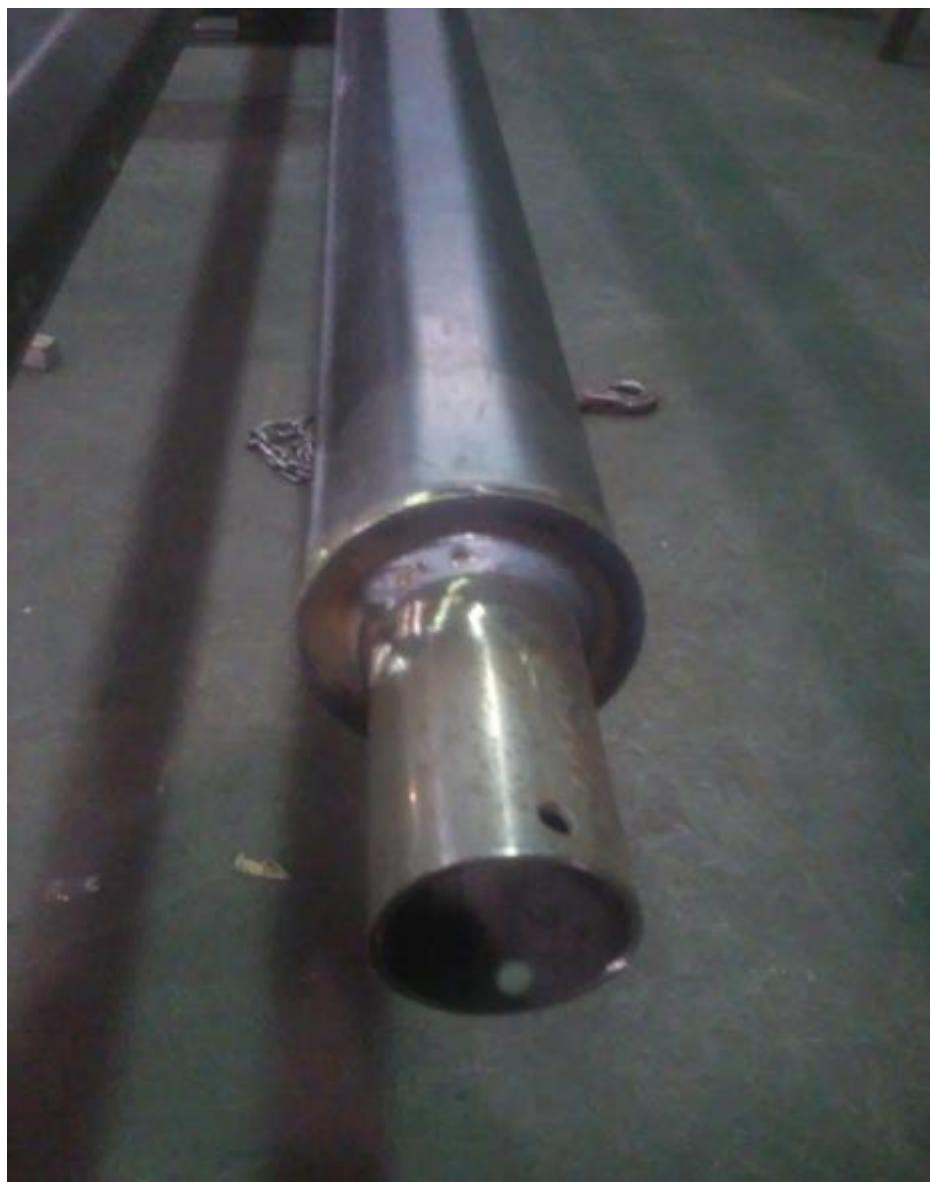
*Slika 5.15. Ugradnja i zavarivanje cijevi umetka*
