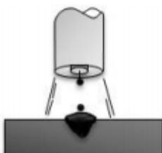
*Slika 3.3. Prijenos metala pulsirajućim lukom – shematski prikaz[6]*
