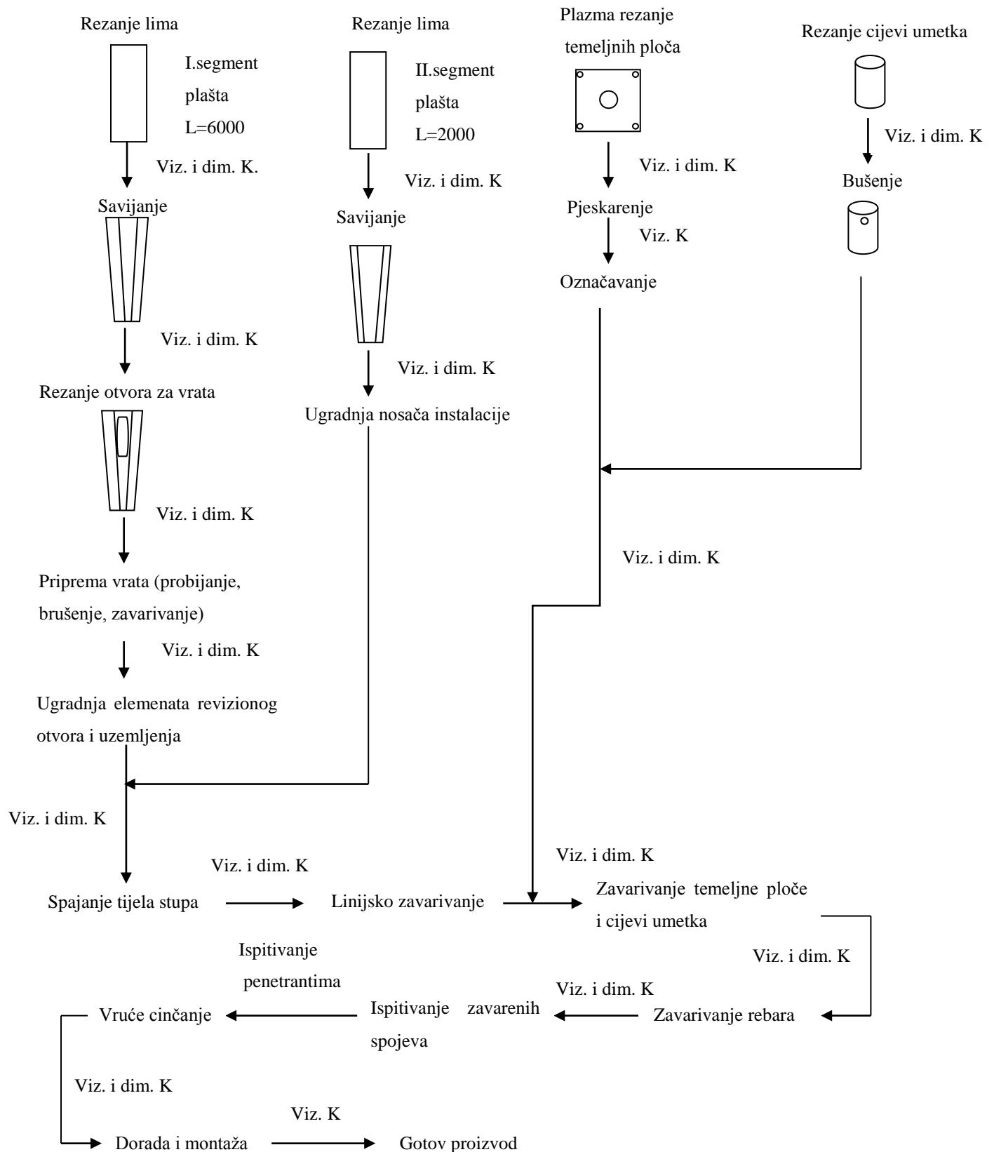
Prva operacija je plazma rezanje temeljnih ploča iz lima S355J2 debljine 20 mm. Rezanje se vrši na Messer CNC plazma rezaču. Temeljne ploče se dalje pjeskare (vanjska usluga) te označavaju brojem radnog naloga.
