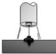
Slika 3.4. Prijenos metala kratkim spojem – shematski prikaz[6]
