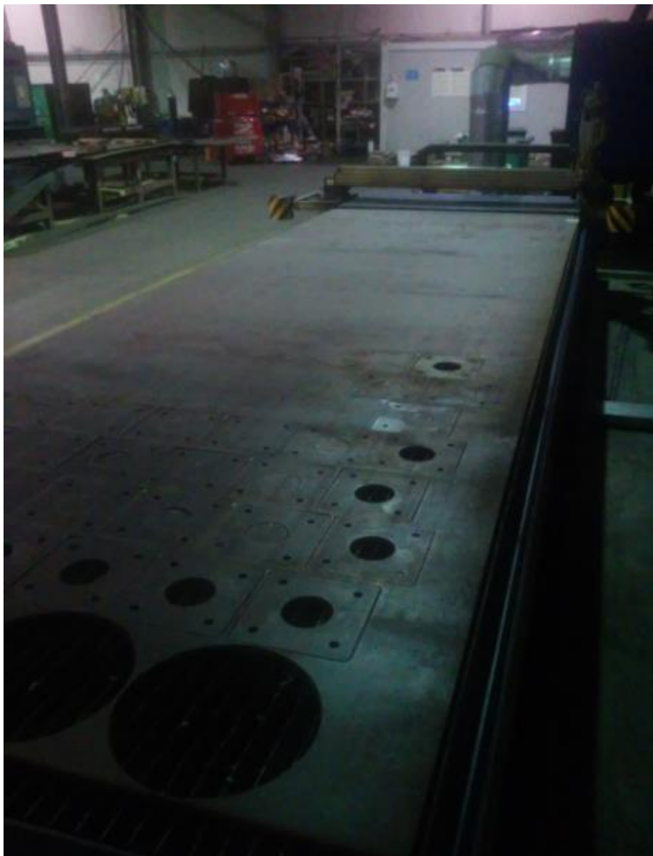
Slika 5.7. CNC plazma rezanje temeljnih ploča
