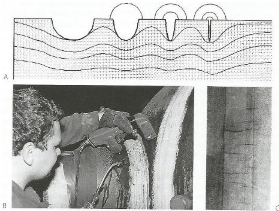
*Slika 4.5 magnetska metoda ispitivanja[5]*
