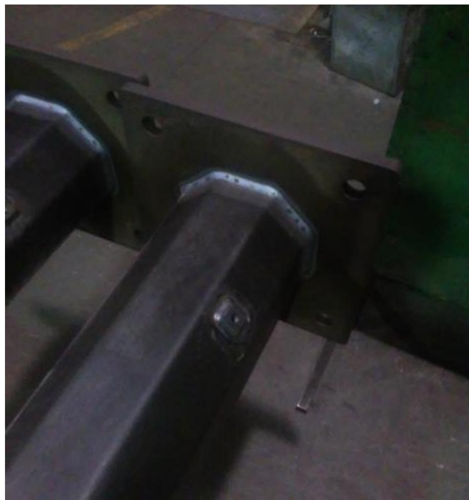
*Slika 5.14. Ugradnja i zavarivanje temeljne ploče*
