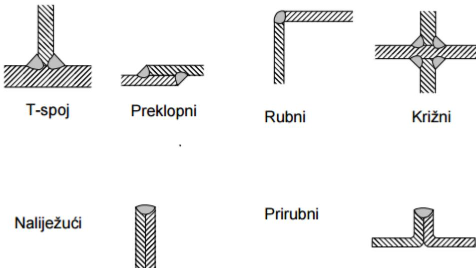
Slika 2.3. Oblici zavarenih spojeva [2]
