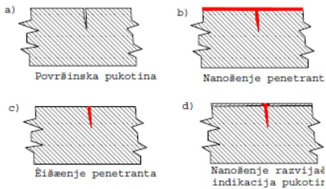
Slika 4.1. Shematski prikaz procedure provođenja kontrole tekućim penetrantima [10]
