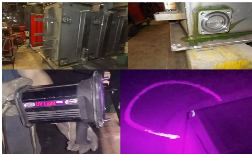
Slika 4.8 Ispitivanje zavarenih spojeva na nepropusnost fluorescentnim penetrantom
