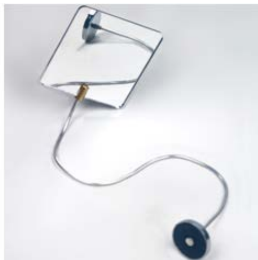
Slika 3.1 Pomagala kod direktne vizualne kontrole (povećalo lijevo, zrcalo desno)
