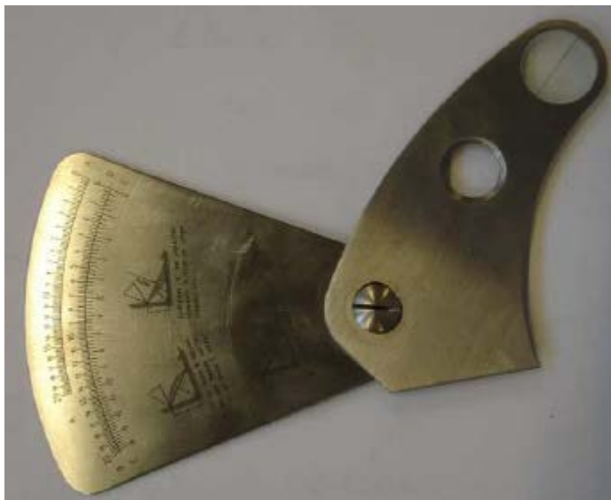
Slika 3.4 Mjerilo s tri skale
