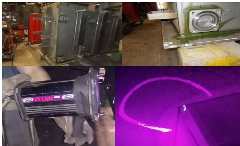
Slika 4.8 Ispitivanje zavarenih spojeva na nepropusnost fluorescentnim penetrantom
