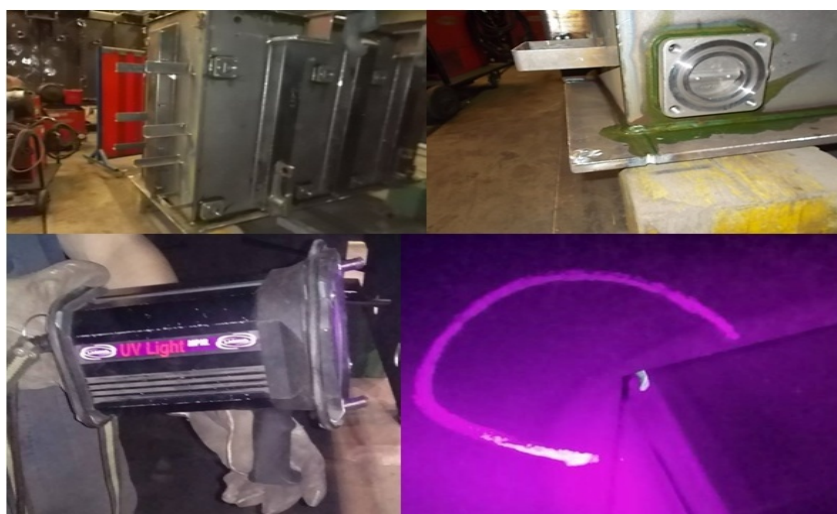
Slika 4.8 Ispitivanje zavarenih spojeva na nepropusnost fluorescentnim penetrantom
