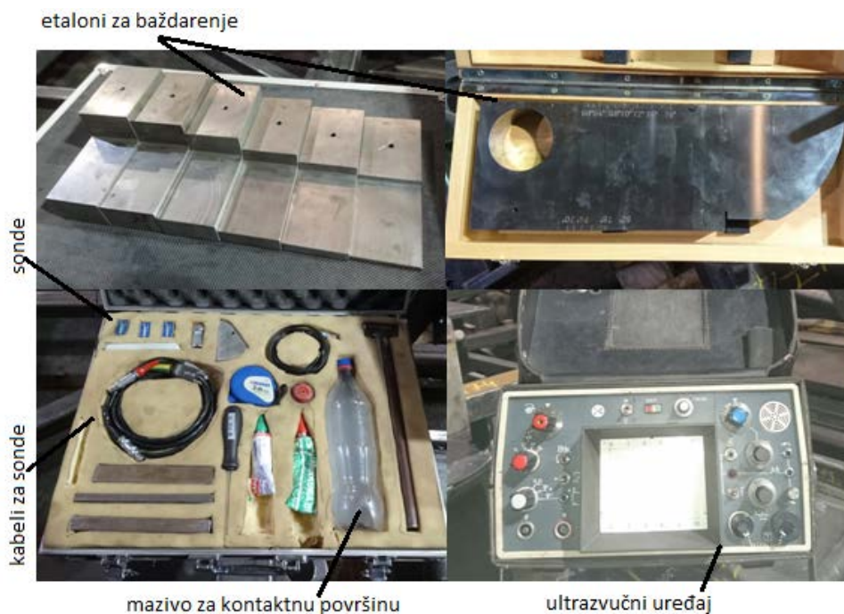
Slika 3.20 Oprema za ispitivanje ultrazvukom
