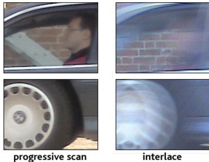
Slika 3.2 Progresivno i isprepletено snimanje
