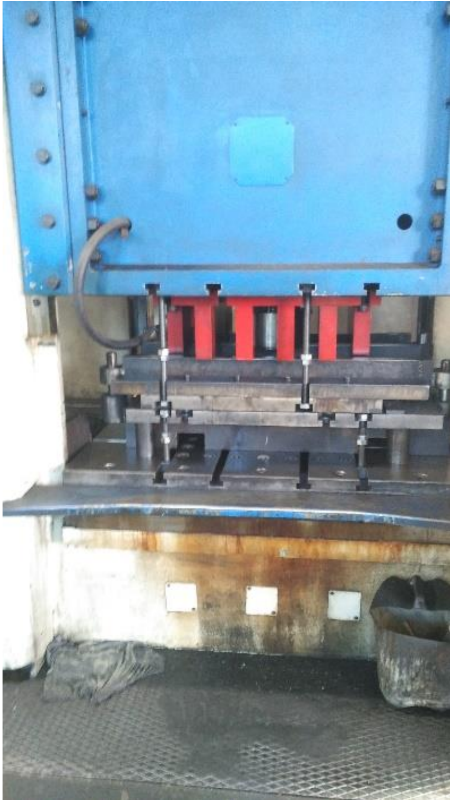
Slika 5.7 hidraulična preša za podnice
