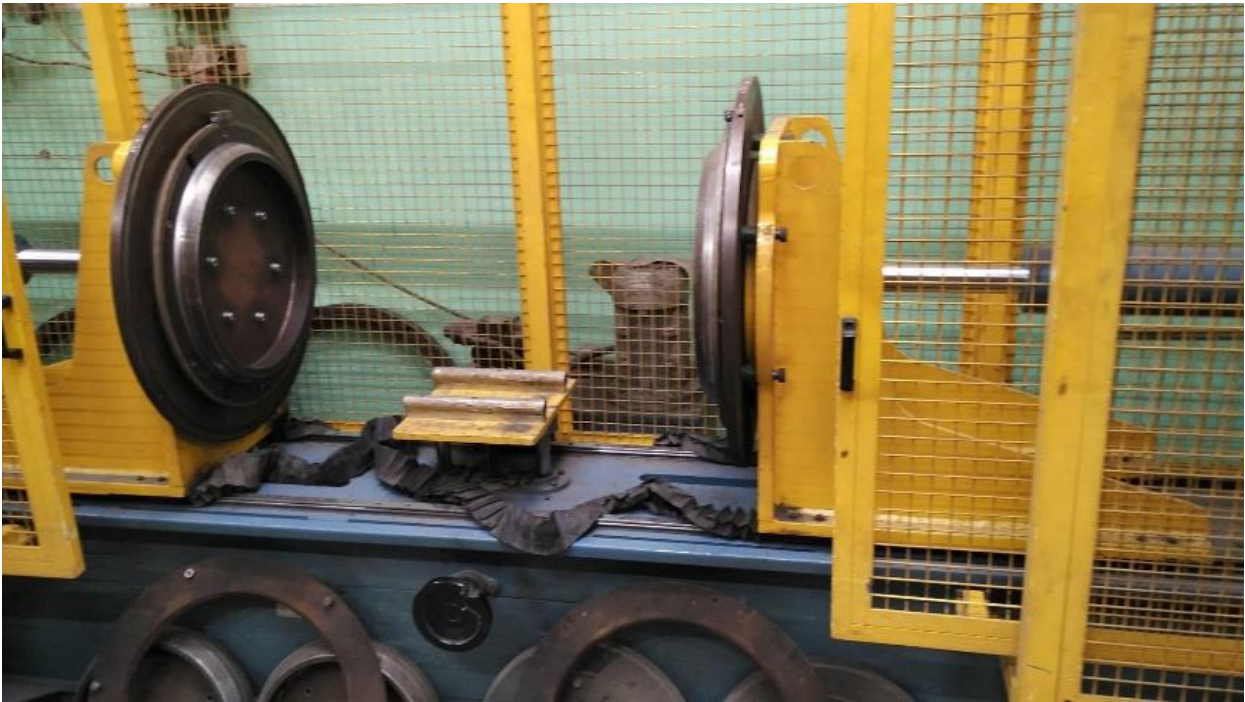
Slika 5.9 stroj za proširivanje rubova podnice
