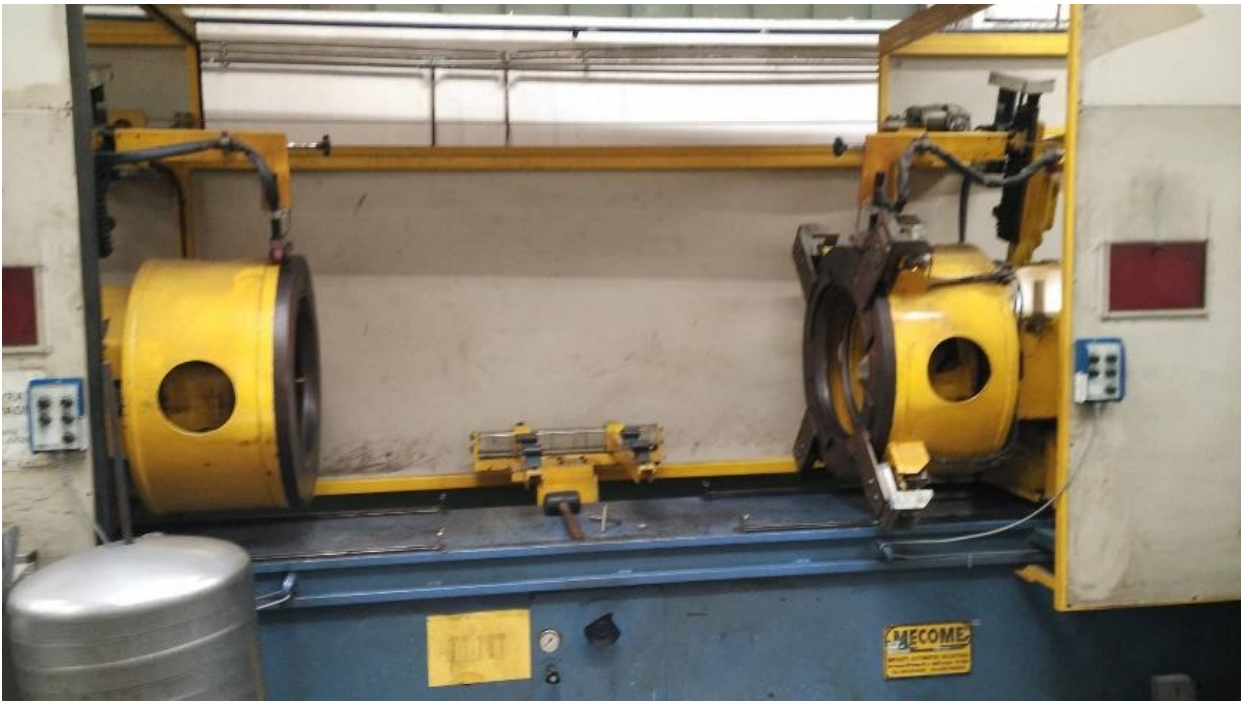
Slika 5.11 automatsko zavarivanje podnice s plaštom
