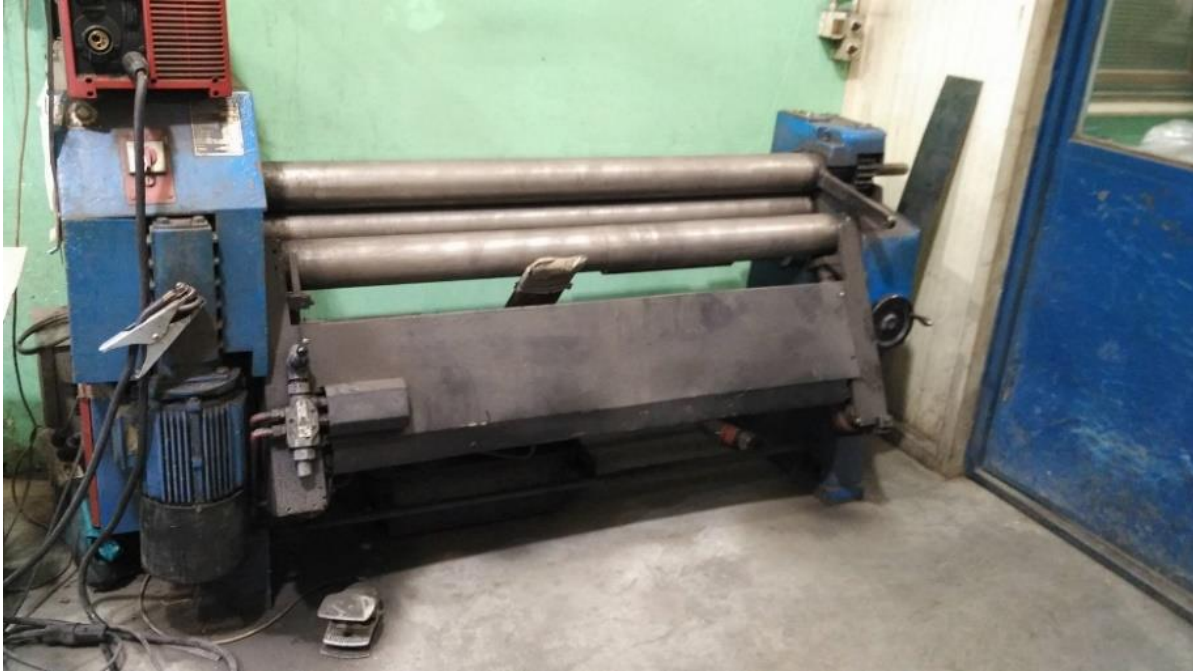
Slika 5.3 stroj za kružno savijanje
