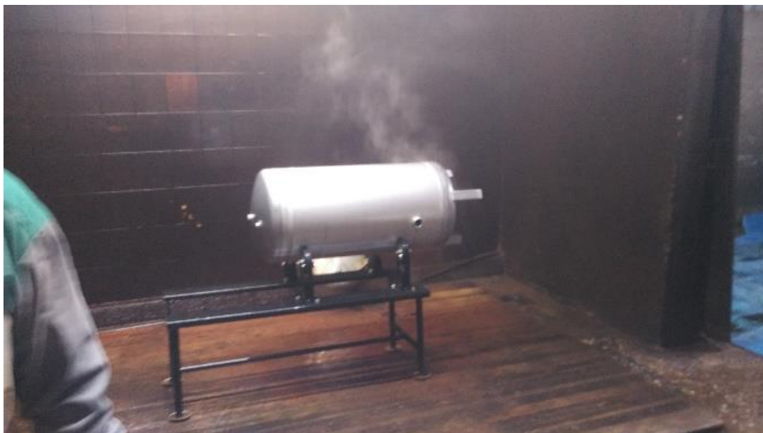
Slika 5.16 kemijsko čišćenje zavara
