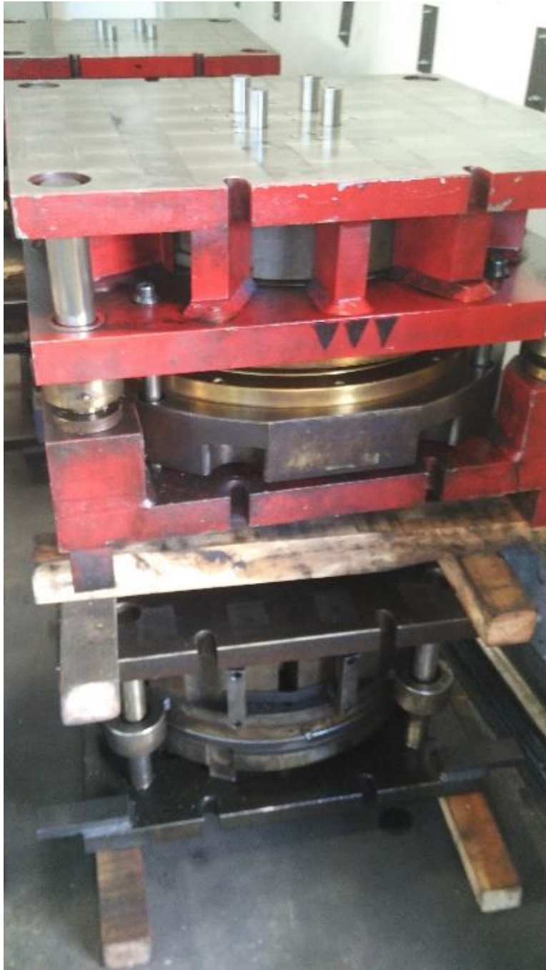
Slika 5.2 alat za probijanje rupa
