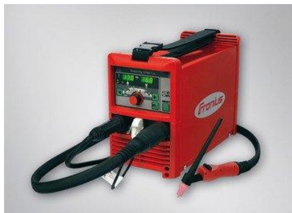
Slika 4.1 aparat za TIG zavarivanje [5]
