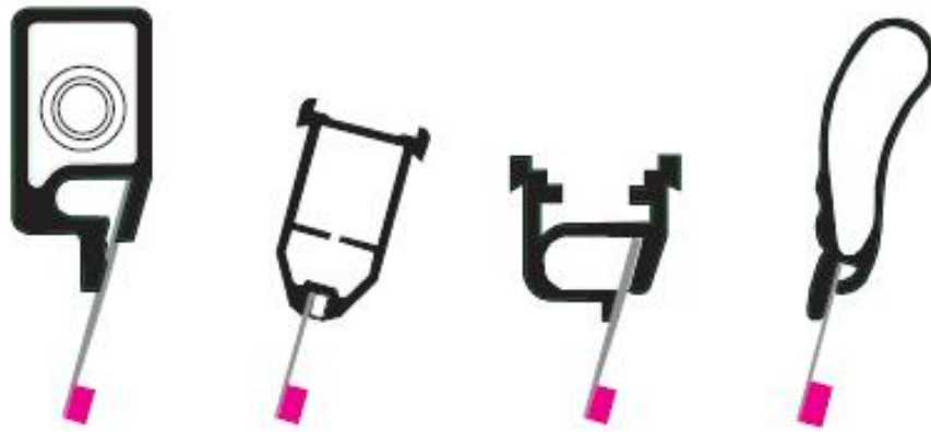
Slika 2.9. RKS rakli - lagano se montiraju, konstantnog su kuta, male potrošnje
