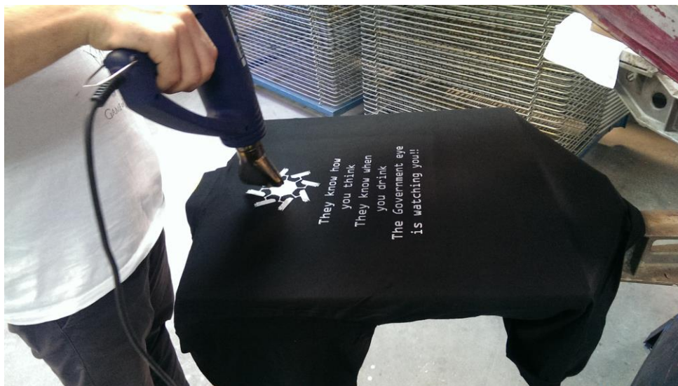
Slika 3.10. Sušenje otiska industrijskim fenom
