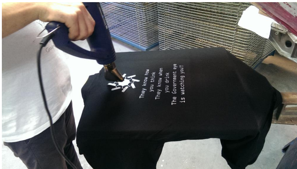
Slika 3.10. Sušenje otiska industrijskim fenom
