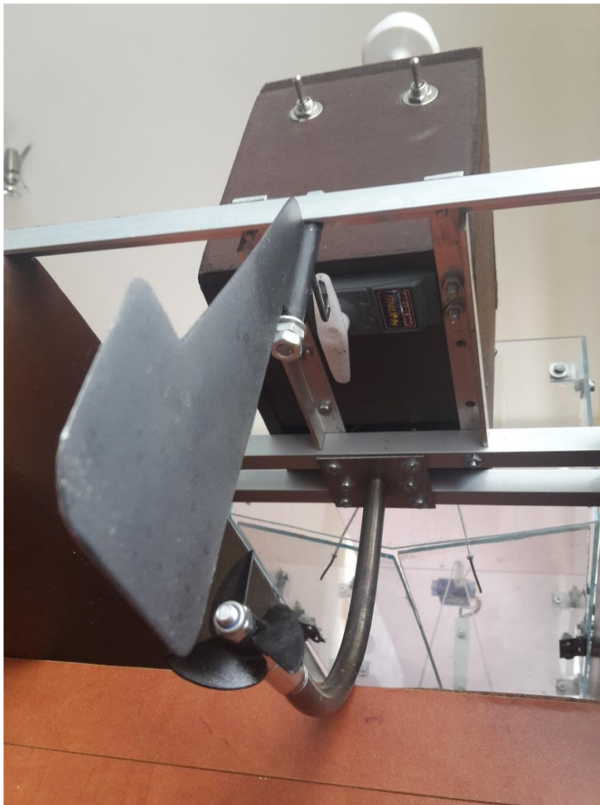
Slika 4.3 Kormilo i spoj na servo motor
