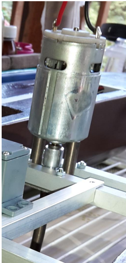
Slika 4.2 Motor za pokretanje modela čamca i spoj na fleksibilno vratilo
