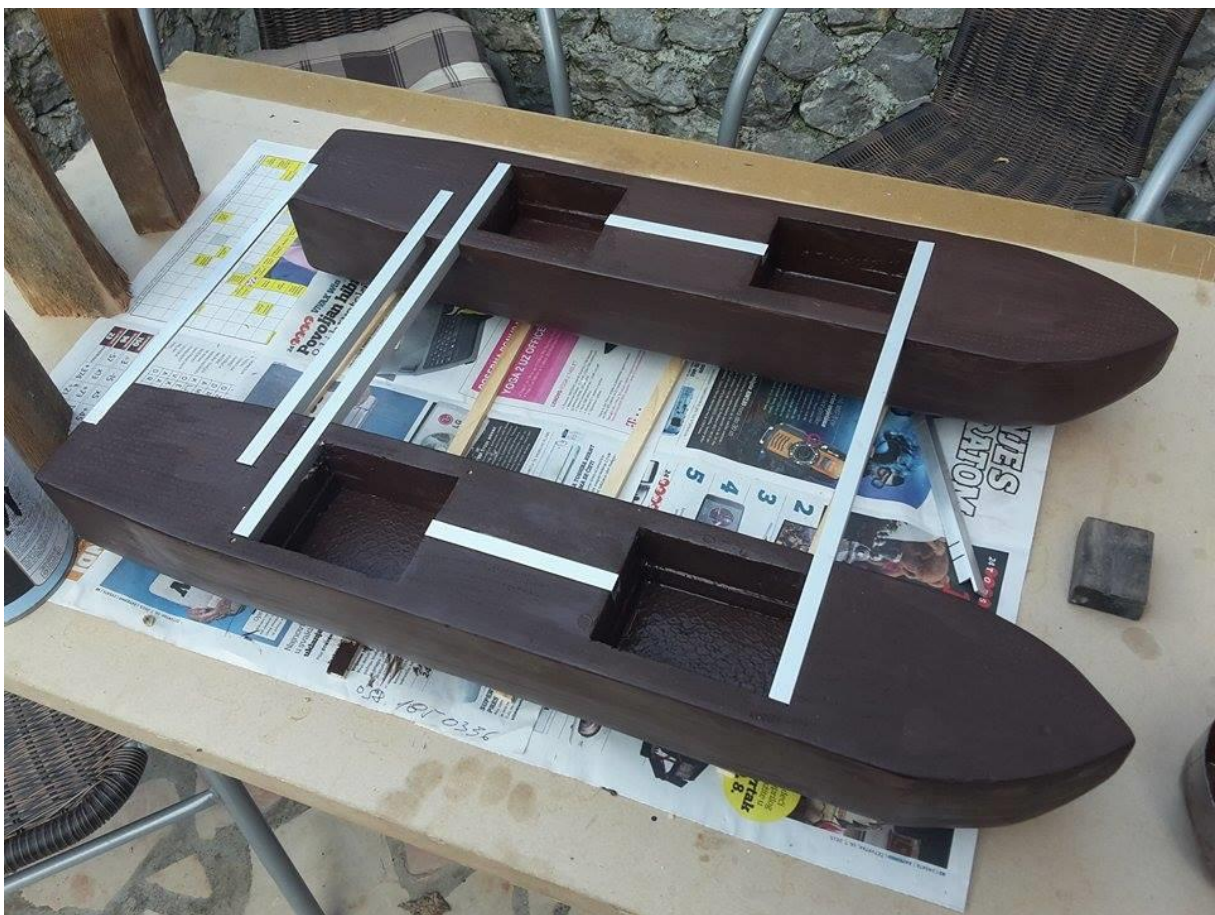
Slika 3.3 Trupovi spojeni aluminijskim profilima
