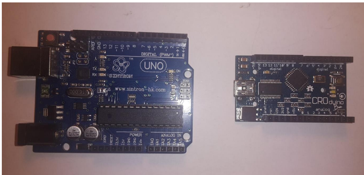
Slika 6.1 Arduino UNO i Croduino pločica
