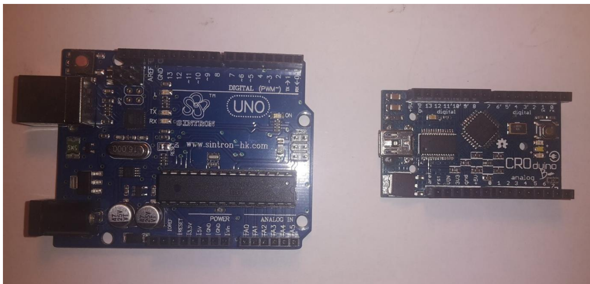
Slika 6.1 Arduino UNO i Croduino pločica
