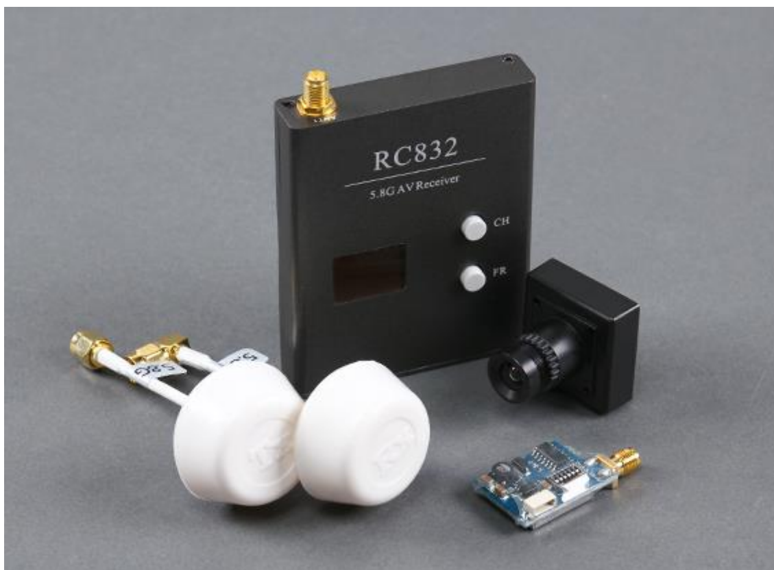
Slika 5.1 Set za video prikaz – SkyZone FPV 200-Set, [14]
