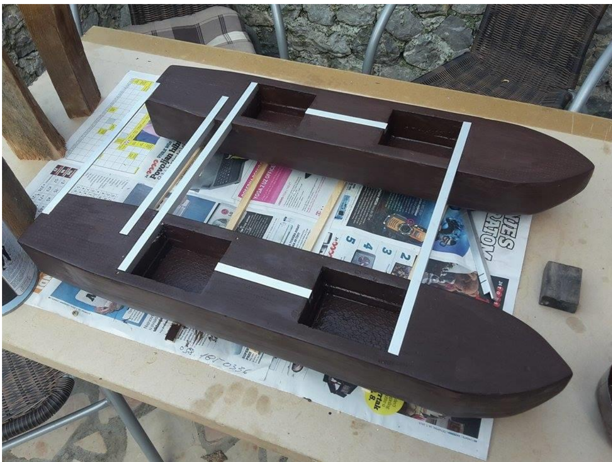
Slika 3.3 Trupovi spojeni aluminijskim profilima
