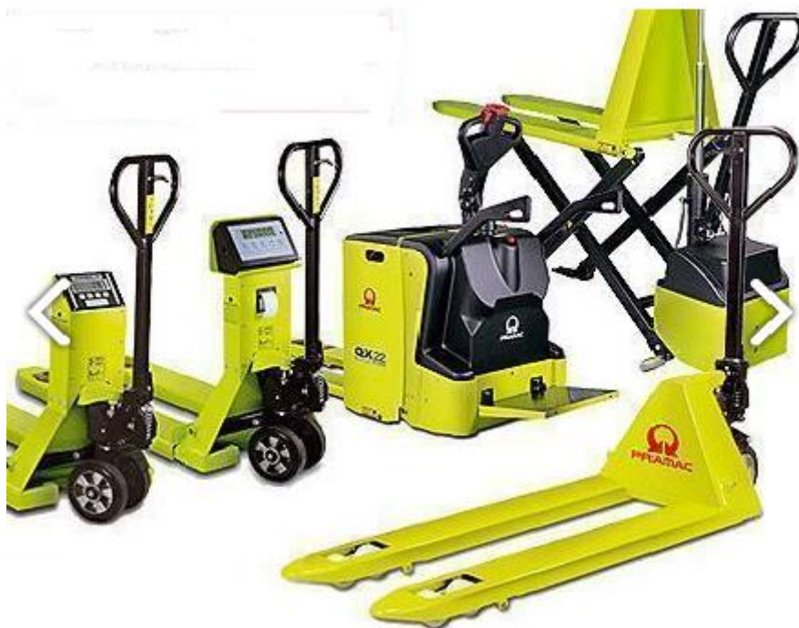
Slika 5: Različite izvedbe ručnih viličara
