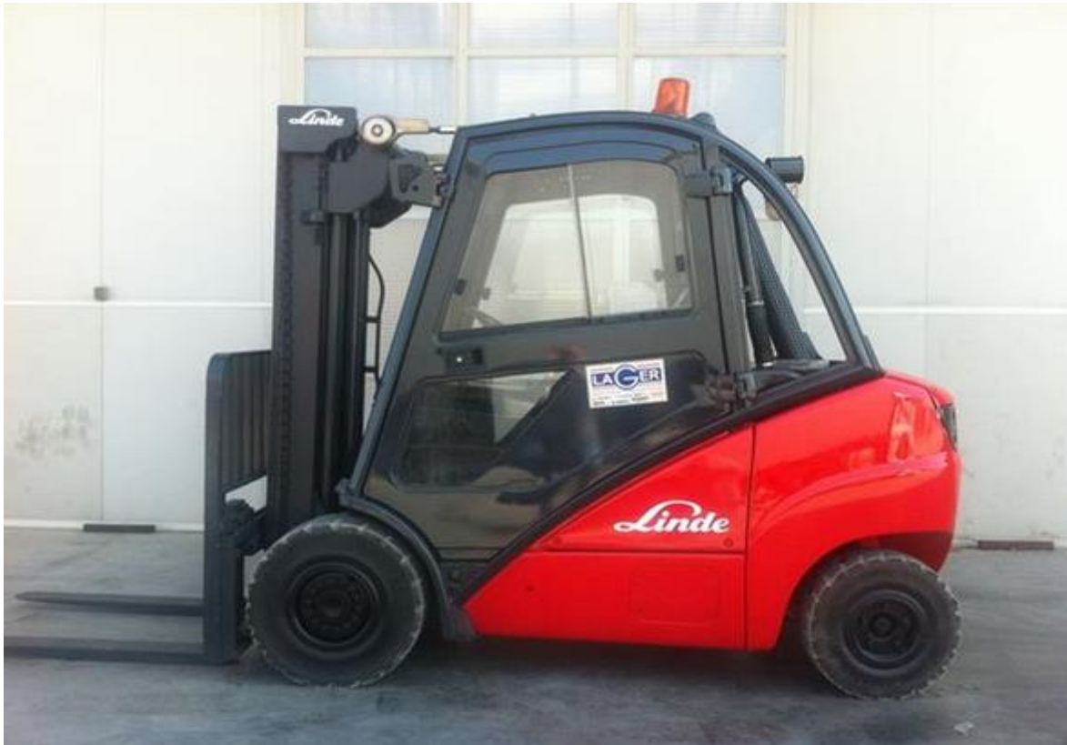
Slika 8: Viličar pogonjen s dieselskim motorom
