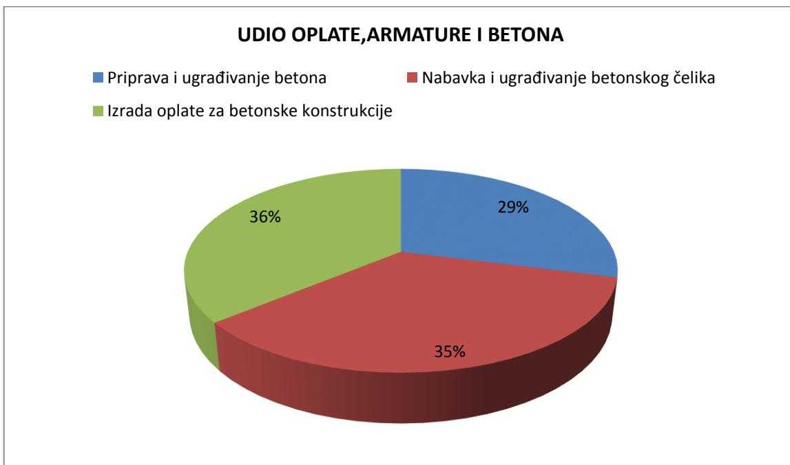
*Slika 2.1.2. Graf strukture cijene na izradi konstrukcije o udjelu oplate, armature i betona*
