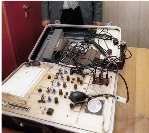
Slika 1: Starija verzija poligrafa-metalni kovčeg 58
