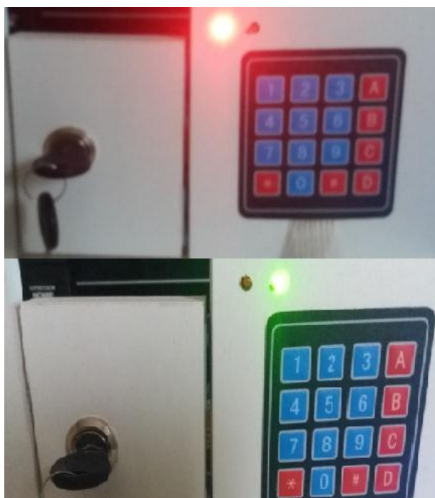
Slika 4.9. Princip rada elektroničke brave
