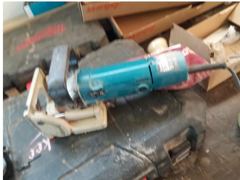
*Slika 4.5. Lamela, glodalica za drvo*
