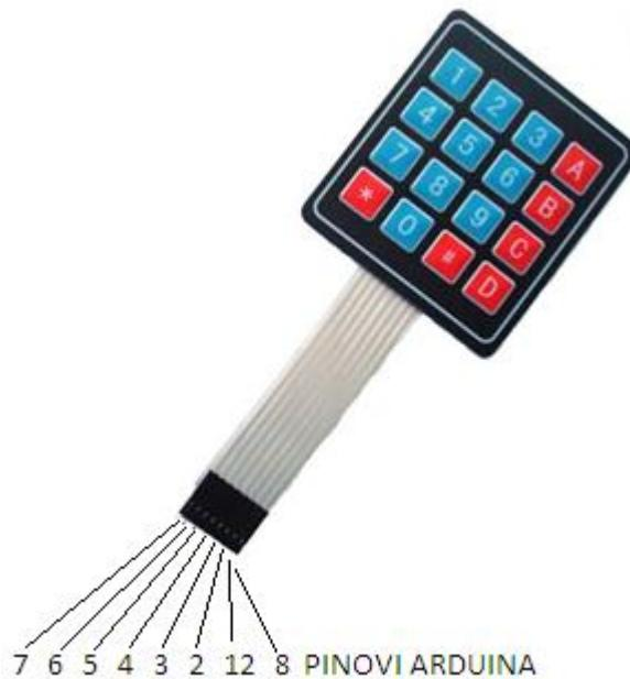
Slika 3.6. Membranska tipkovnica 4x4
