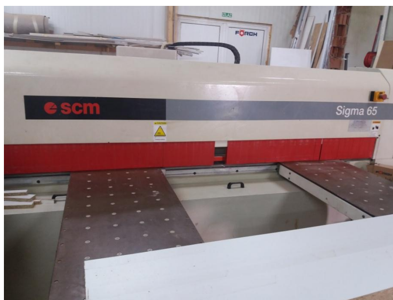
Slika 4.3. Krojač ploča SCM SIGMA 65
