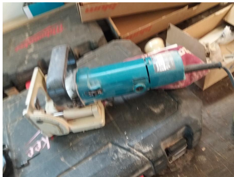
Slika 4.5. Lamela, glodalica za drvo
