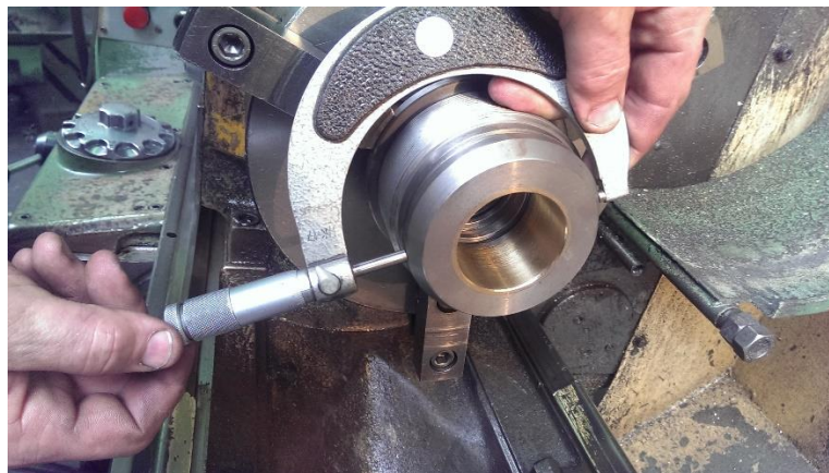
Slika 4.8: Kontrola vanjske mjere pomoću mikrometra
