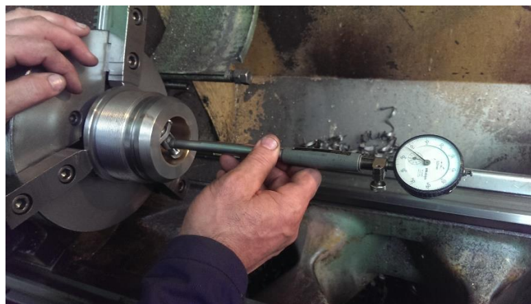
Slika 4.9: Kontrola unutarnje mjere pomoći subitora
