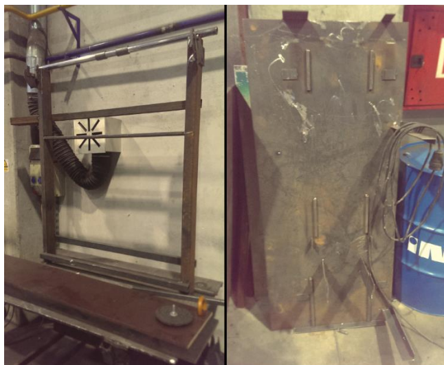
Slika 4.15: Šablone za zavarivanje
