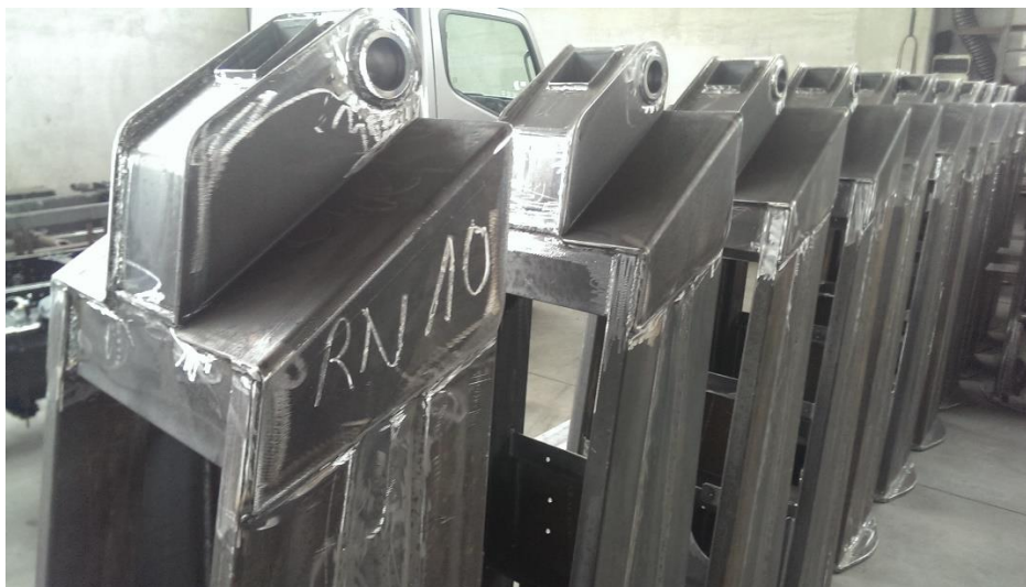
Slika 4.19: Označavanje i skladištenje zavarenih konstrukcija
