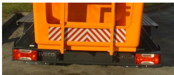
Slika 5.6: Pregled označenosti dijelova koji prelaze gabarite vozila
