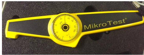
Slika 4.24: MikroTest – Uređaj za mjerenje debljine sloja boje
