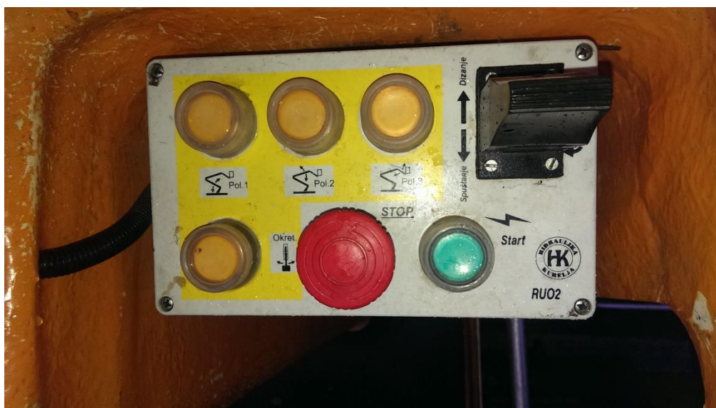
Slika 3.8: Upravljači uređaj za upravljanje iz košare
