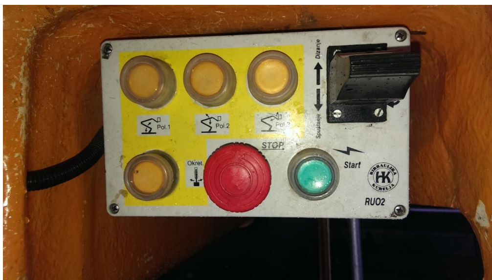
Slika 3.8: Upravljači uređaj za upravljanje iz košare
