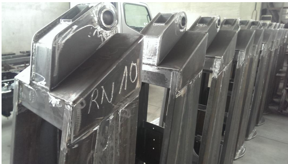
Slika 4.19: Označavanje i skladištenje zavarenih konstrukcija
