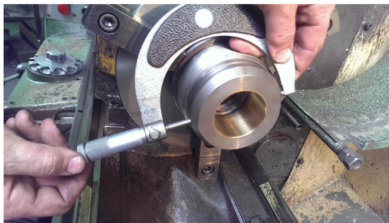
Slika 4.8: Kontrola vanjske mjere pomoću mikrometra
