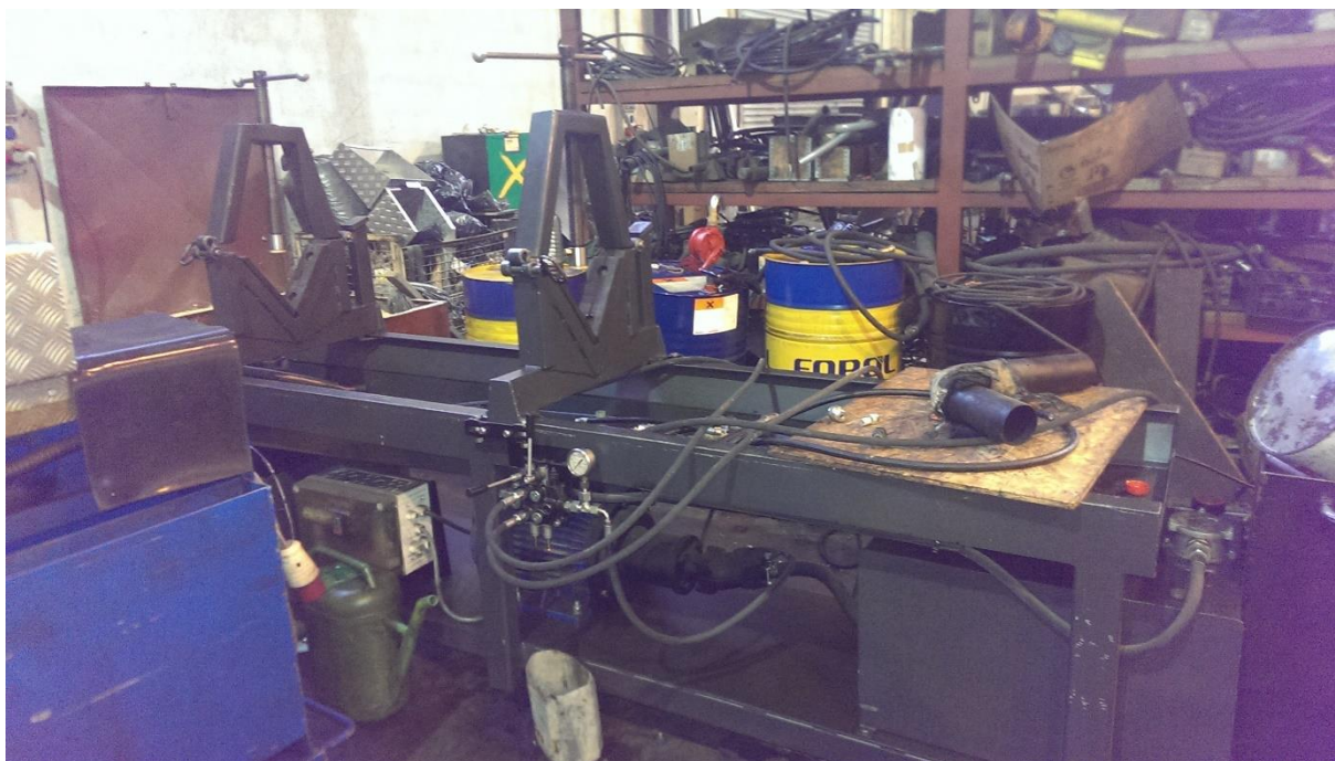
Slika 4.21: Naprava za kontrolu hidrauličkih cilindara
