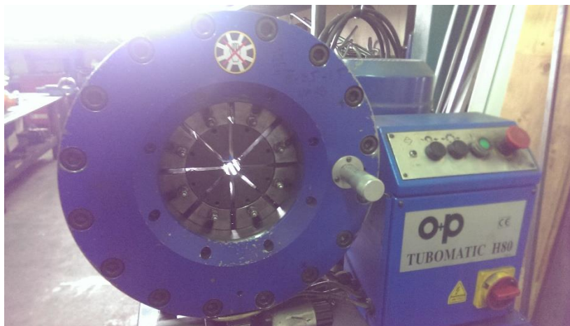
Slika 5.20: Stroj za spajanje čahura
