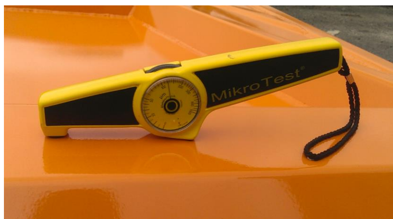
Slika 4.25: Završno mjerenje debljine sloja boje
