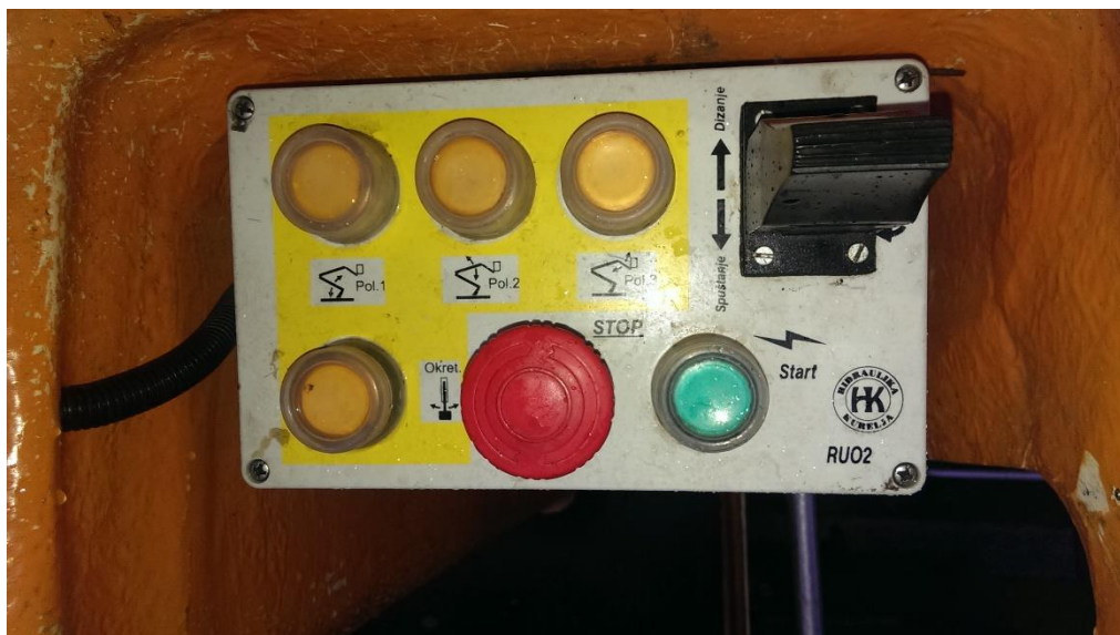
Slika 3.8: Upravljači uređaj za upravljanje iz košare
