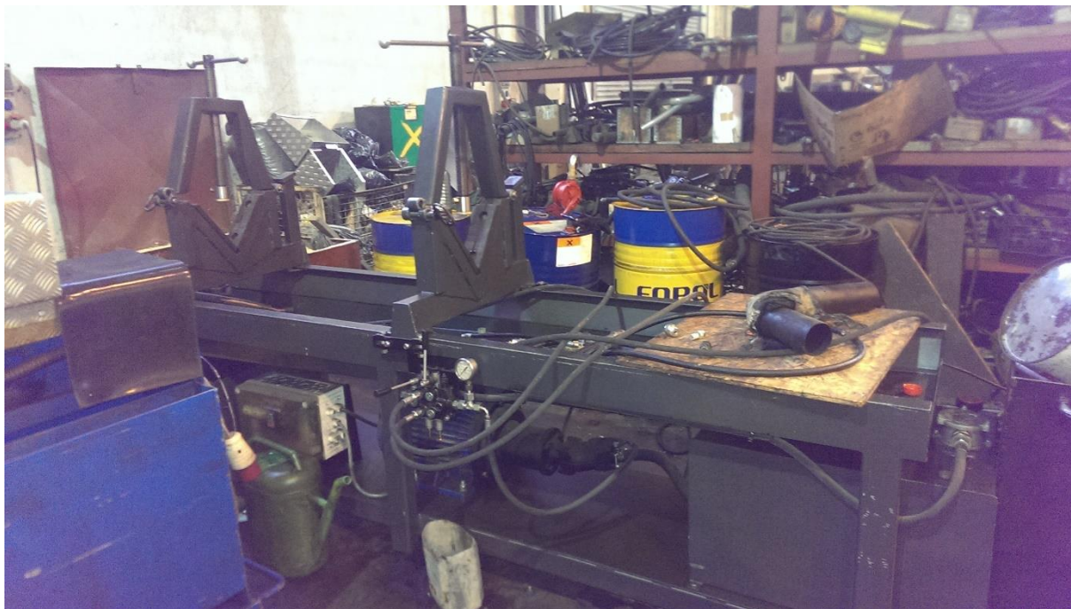
Slika 4.21: Naprava za kontrolu hidrauličkih cilindara
