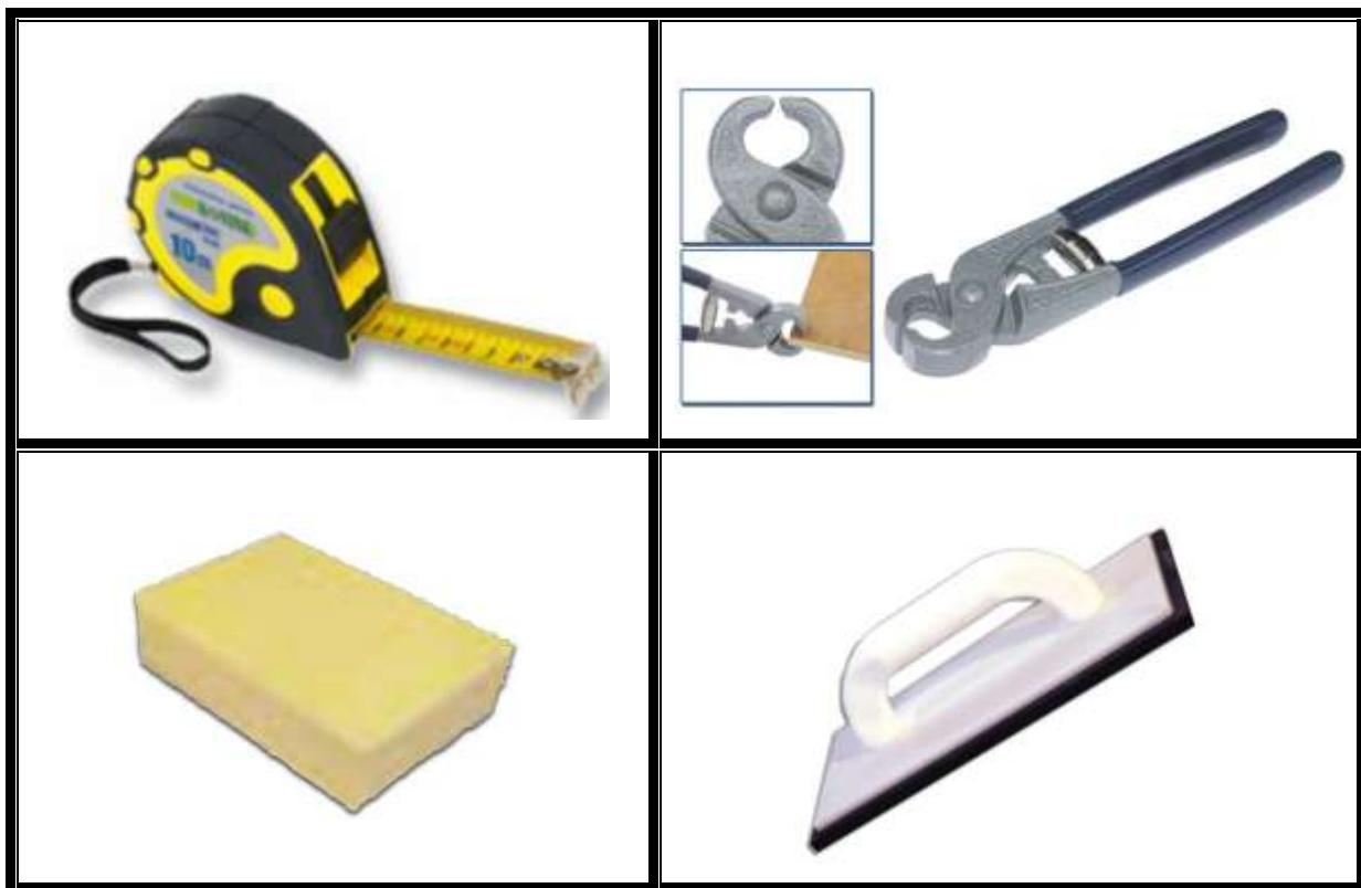
*slika 6.9.: metar, kliješta, spužva, gumeni "gleter"*
