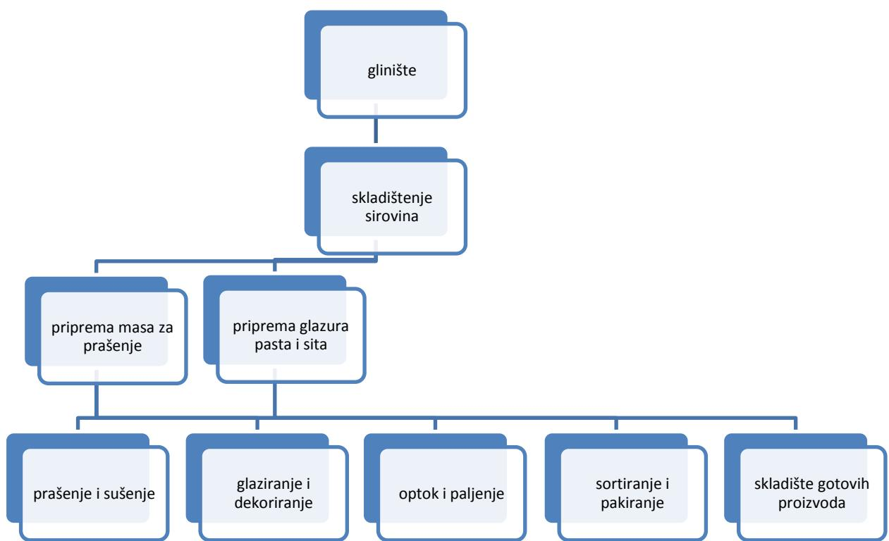
Shema 1: proces proizvodnje keramičkih pločica
