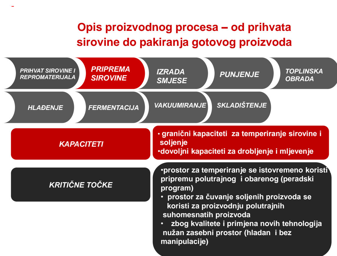
Slika 3.1 Opis proizvodnog procesa - priprema sirovine [7]
