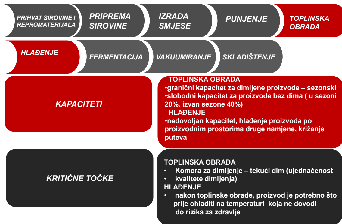
Slika 3.4 Opis proizvodnog procesa - toplinska obrada i hlađenje [7]
