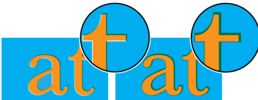
Slika 1.1. Pogreška u registru tiska bez primjene trappinga (lijevo) i sa trappingom (desno)
