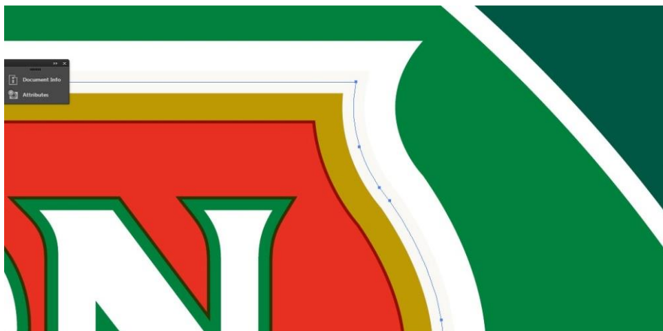
Slika 4.17. Upuštanje (eng. choke)
