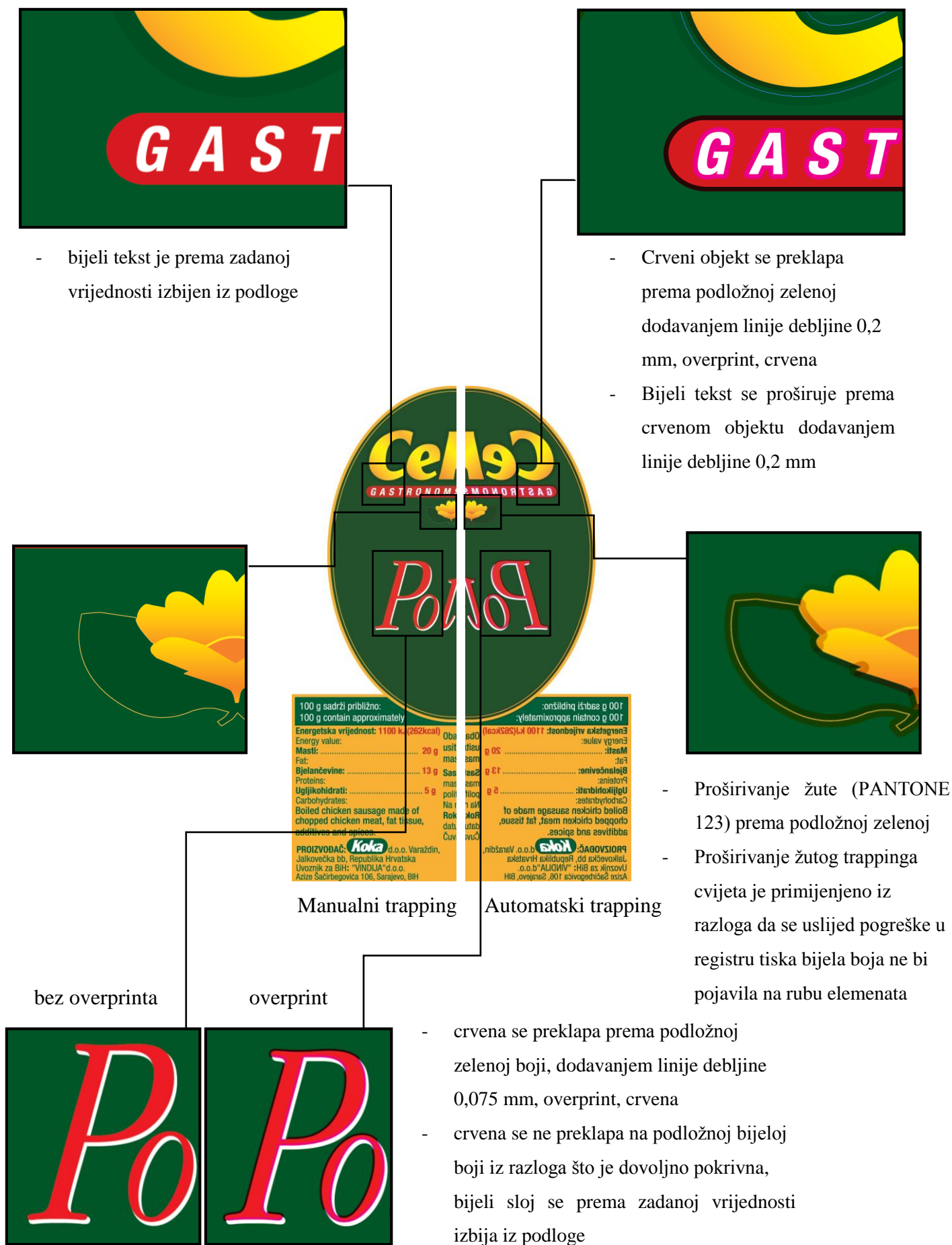
Slika 5.10. Usporedba trappinga fleksibilne etikete „CEKIN – Poliko“
