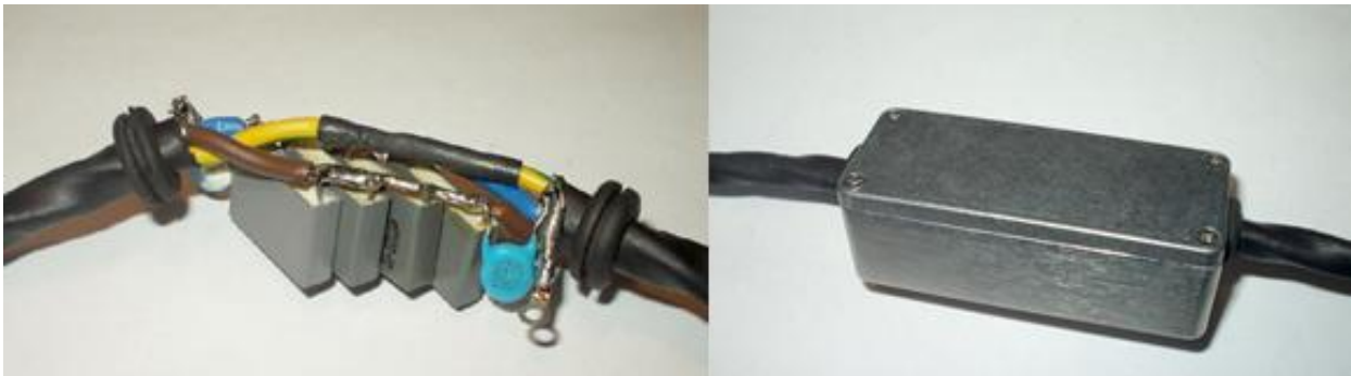
Slika 4.6 Paralelni mrežni filter MOX_MFP2 [16]
