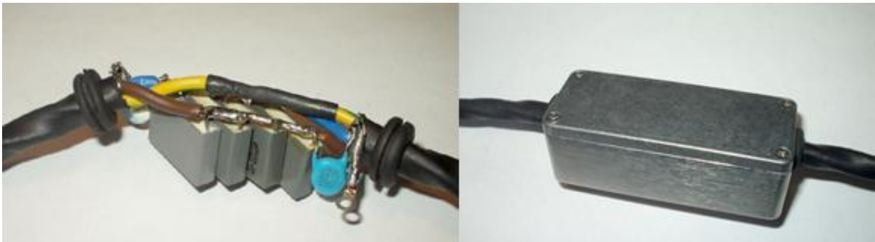
Slika 4.6 Paralelni mrežni filter MOX_MFP2 [16]
