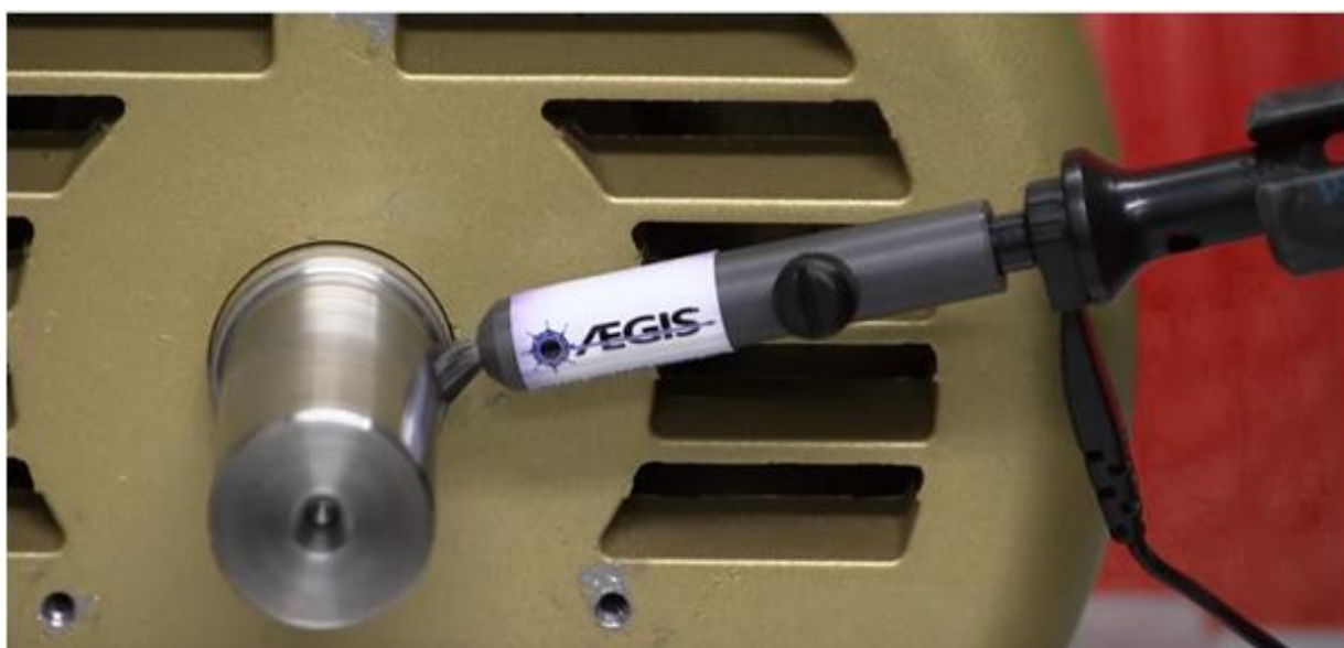
Slika 4.11 Bliži prikaz kontakta osovine u vrtnji i sonde digitalnog osciloscopa [19]
