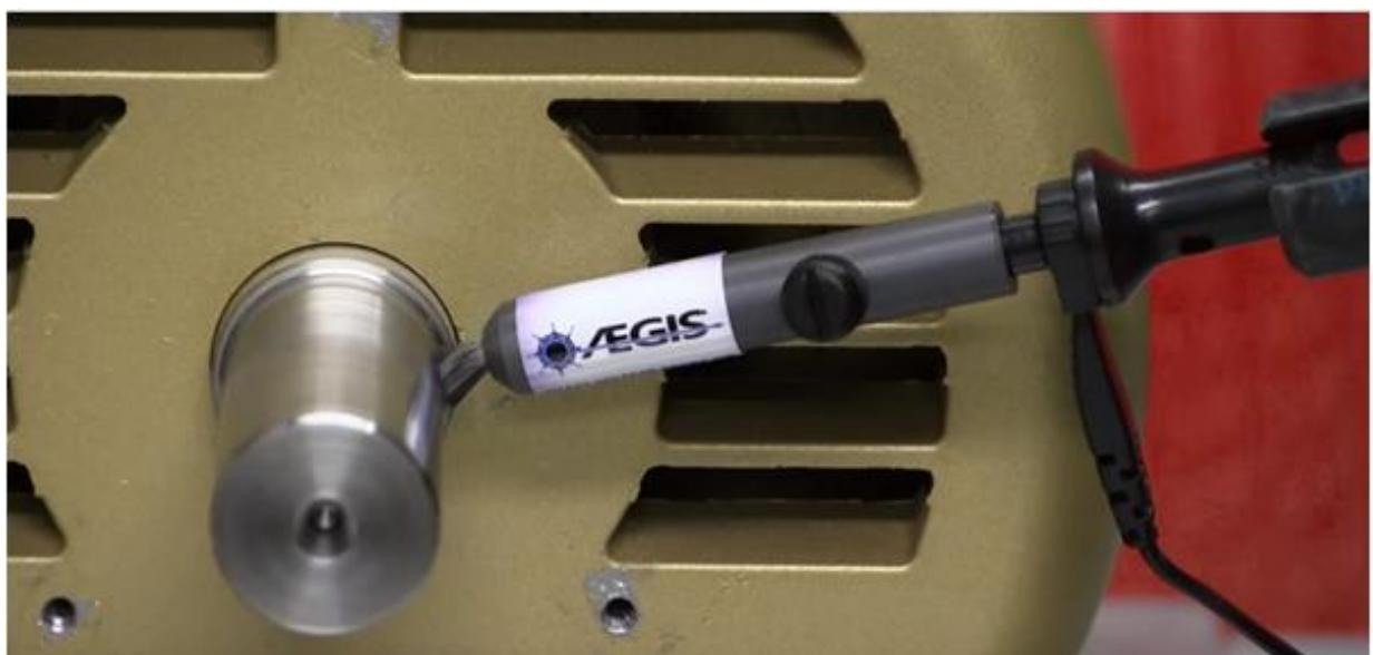
Slika 4.11 Blizi prikaz kontakta osovine u vrtnji i sonde digitalnog osciloskopa [19]
