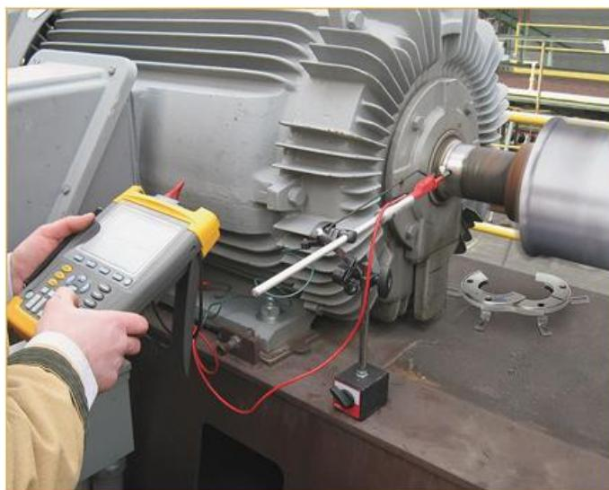
Slika 4.10 Mjerjenje osovinskog napona digitalnom osciloskopom sa magnetskim držačem[18]
