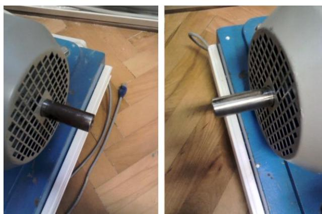
Slika 6.1.a) Osovina drugog elektromotora, b) Osovina trećeg elektromotora
