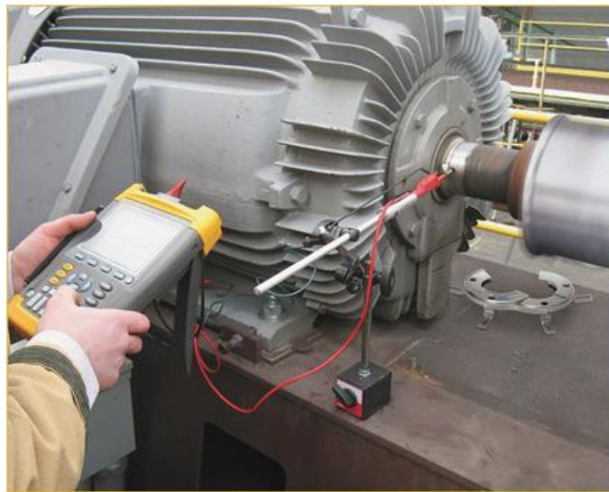
Slika 4.10 Mjerenje osovinskog napona digitalnom osciloskopom sa magnetskim držačem[18]
