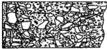
Slika 19.1. Tipičan uzorak unutarnjeg raspucavanja uzrokovanog unutarnjim zamrzavanjem u betonu
