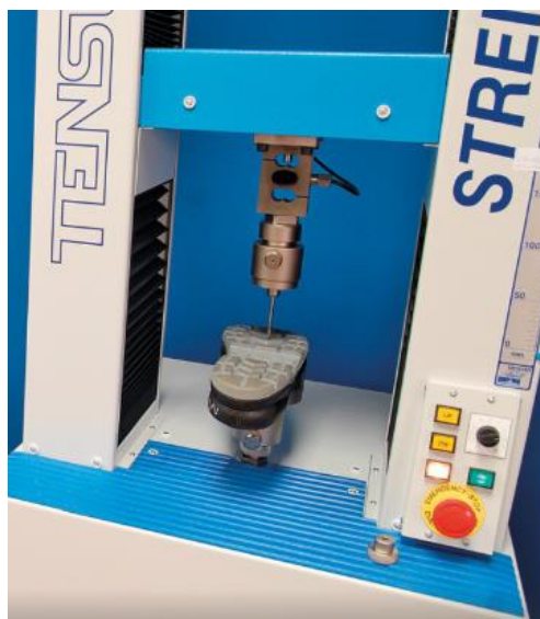
Slika 7.4. Postupak ispitivanja kvalitete potplata
