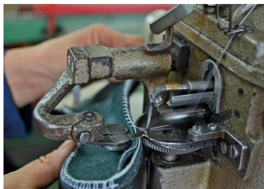
Slika 2.13. Šivanje temeljne tabanice - štrobl
