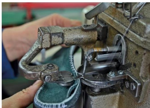
Slika 2.13. Šivanje temeljne tabanice - štrobl
