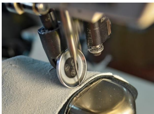
Slika 2.12. Šivanje podstave na lice
