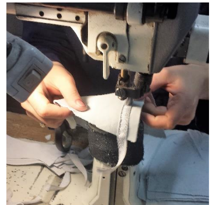
Slika 2.9. Šivanje antistatik trake
