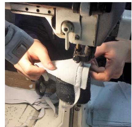
*Slika 2.9. Šivanje antistatik trake*
