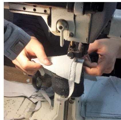
Slika 2.9. Šivanje antistatik trake
