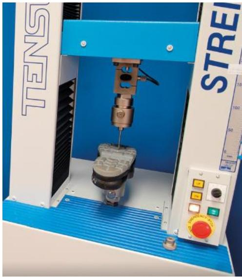
Slika 7.4. Postupak ispitivanja kvalitete potplata
