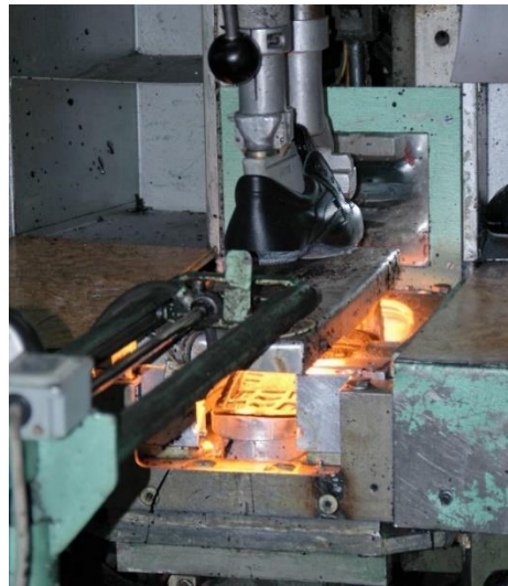
Slika 2.18. Navlačenje i centriranje gornjišta na formu
