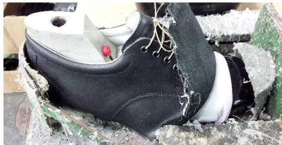
Slika 2.14. Potiskivanje zaštitne kapice
