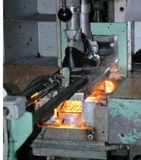
Slika 2.18. Navlačenje i centriranje gornjišta na formu
