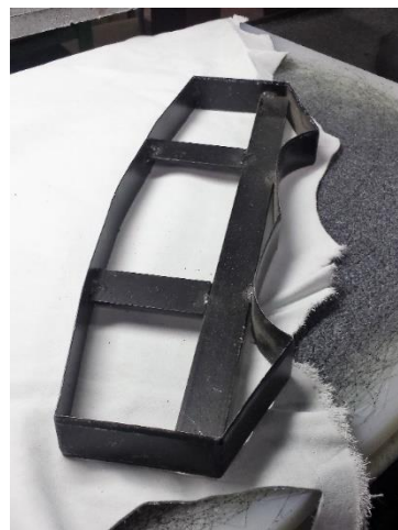
Slika 2.6. Krojenje pojačanja nadringle
