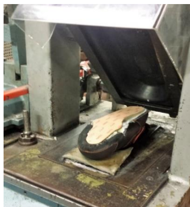
Slika 2.16. Prešanje temeljne tabanice
