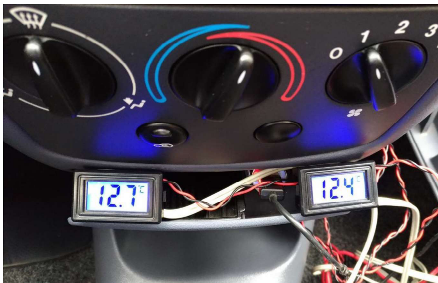
Slika 3.31 Smještanje termometara u automobil
