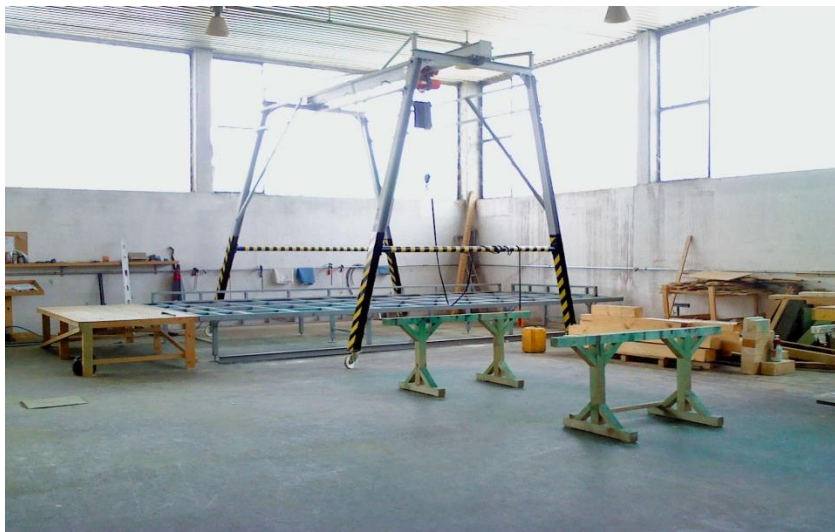
Slika 34. Dizalica i postolje na kojem se gradi zid u proizvodnom pogonu
