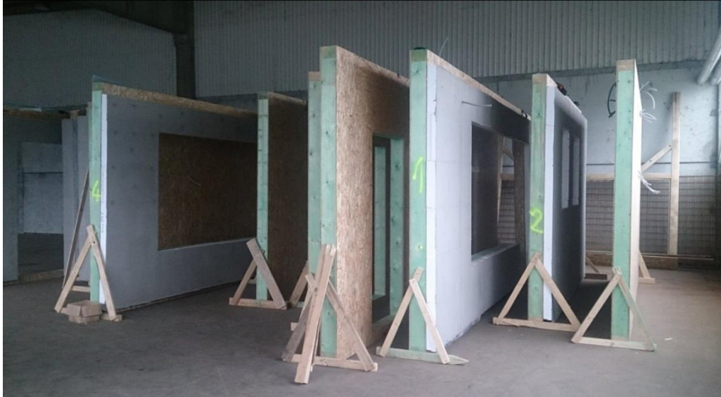
Slika 36. Gotovi zidovi spremni za utovar na kamion
