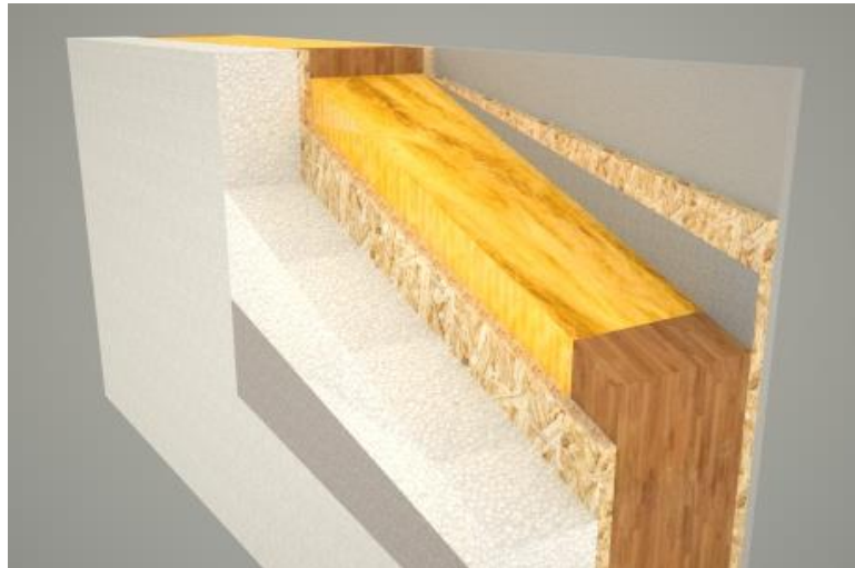
Slika 28. Presjek zida u 3D
