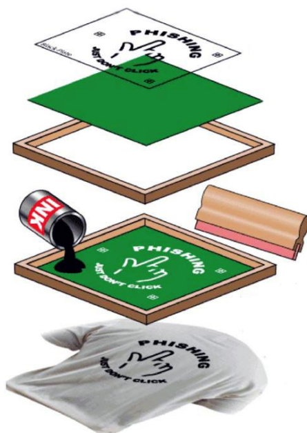
Slika 2.2. Standardni princip sitotiska
