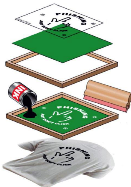
Slika 2.2. Standardni princip sitotiska
