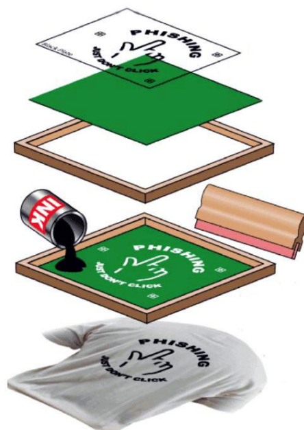
Slika 2.2. Standardni princip sitotiska
