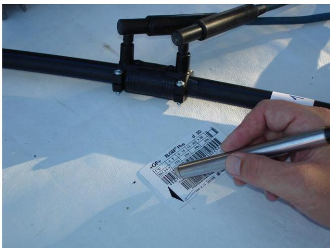
Slika 3.19. Očitavanje barkoda sa magnetske kartice kod zavarivanja prvog uzorka [13]
