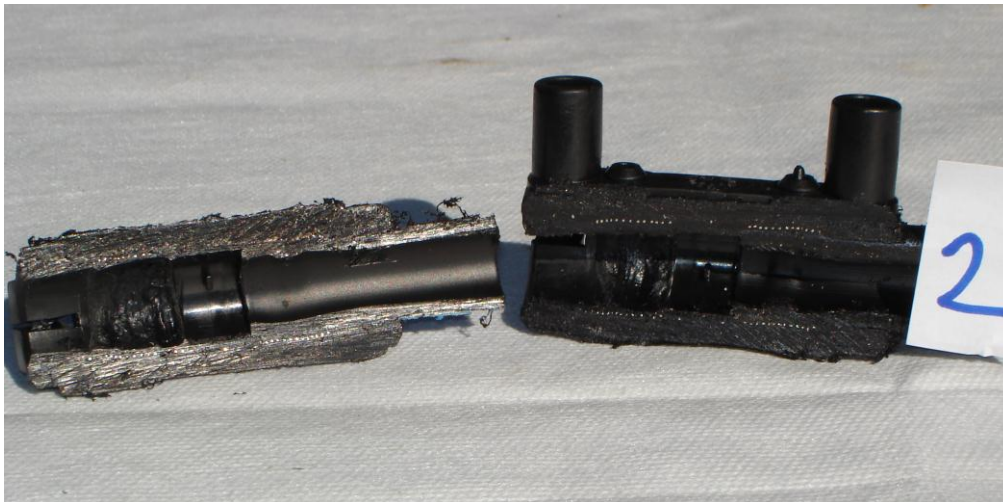
Slika 4.6. Presjek cijevi i elektrospojnice kod uzorka br.2 [13]
