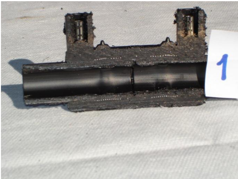
Slika 4.1. Presjek cijevi i elektrospojnice kod uzorka br.1 [13]
