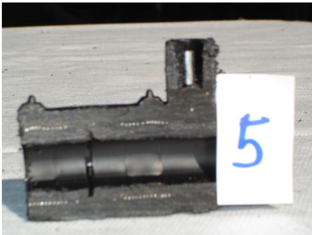
Slika 4.8. Presjek cijevi i elektrospojnice kod uzorka br. 5 [13]
