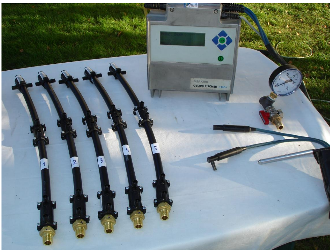
Slika 3.18. Pripremljeni uzorci i oprema za elektrofuzijsko zavarivanje [13]
