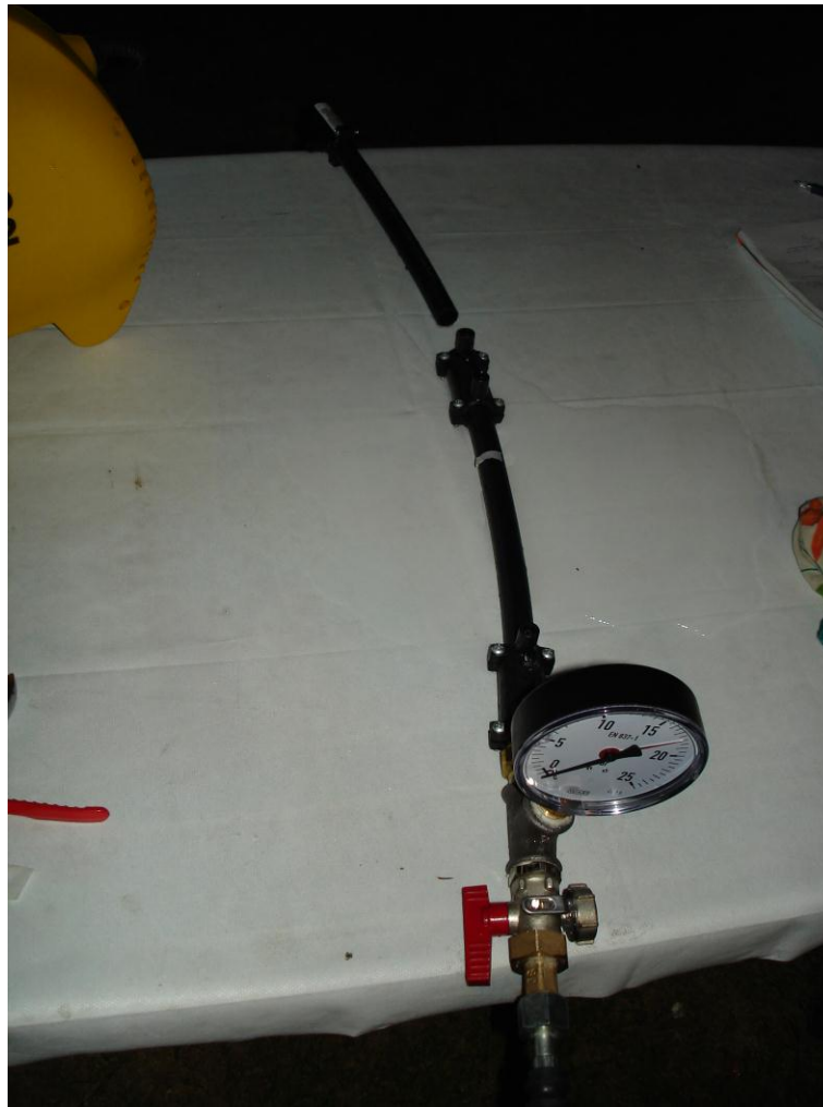
Slika 4.5. Ponovljeno tlačno ispitivanje uzorka br. 2. [13]
