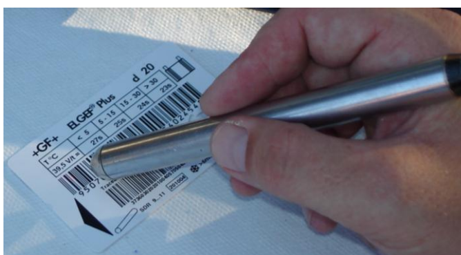
Slika 3.15. Čitanje barkoda čitačem sa magnetske kartice [13]
