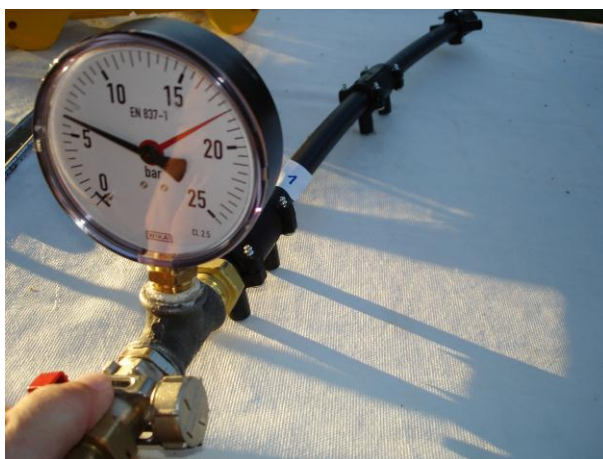
Slika 3.32. Tlačenje uzorka br. 1 na tlak od 6 bara [16]
