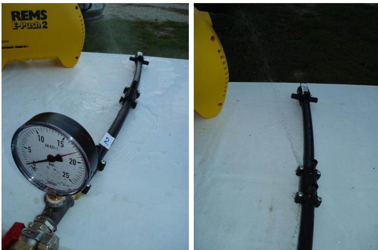
Slika 3.34. Tlačno ispitivanje uzorka br. 2 a) prikaz tlaka kod kojeg dolazi do propuštanja spoja
