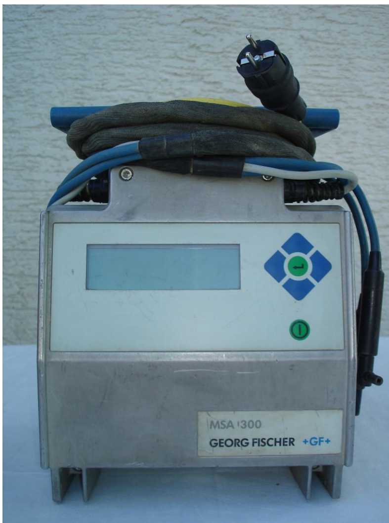
Slika 3.12. Aparat za elektrofuzijsko zavarivanje GEORG FISCHER + GF+ MSA 300 [13]
