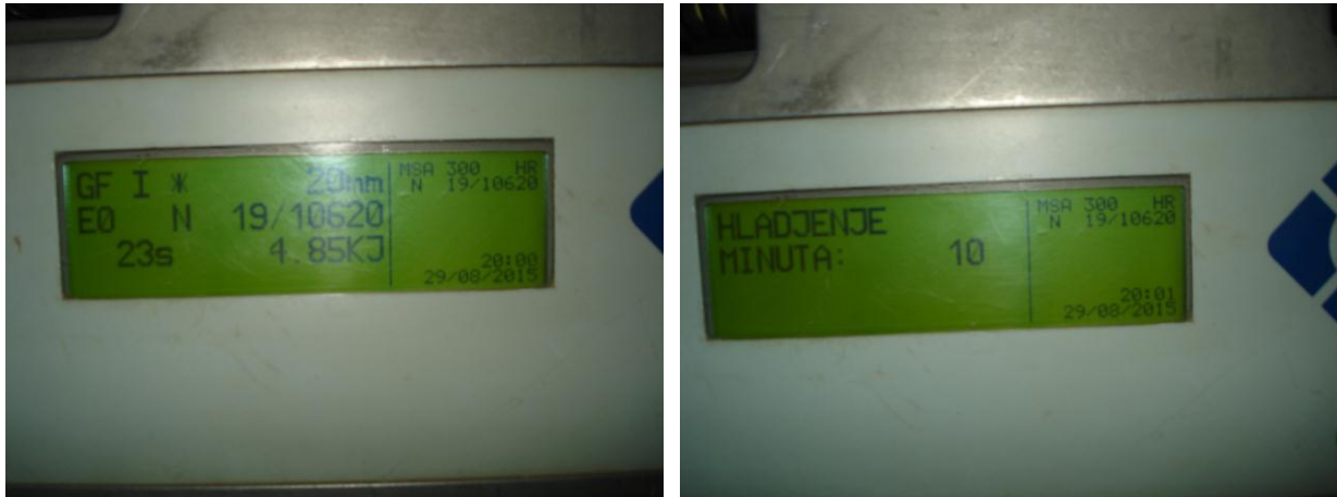
Slika 3.30. Prikaz podataka na zaslonu aparata a) za vrijeme zavarivanja b) za vrijeme postupka hlađenja [13]
