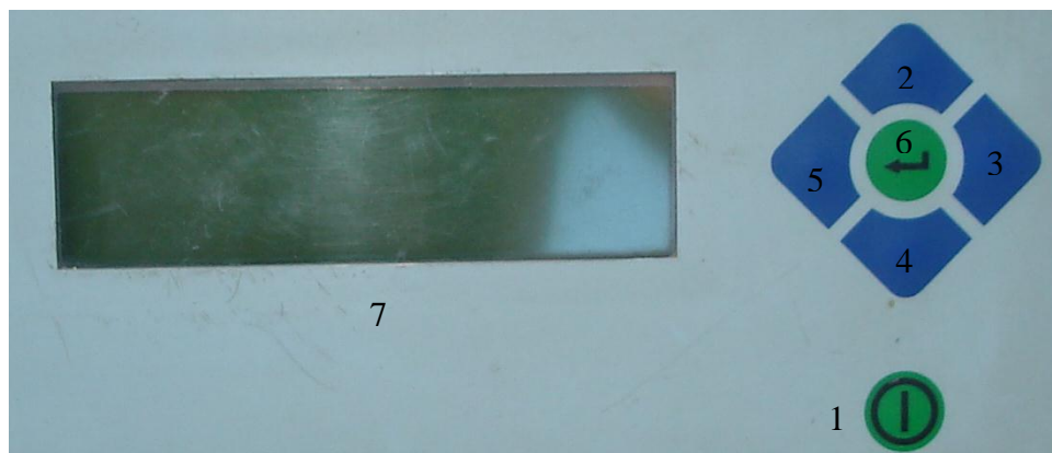
Slika 3.13. Upravljačka ploča aparata za elektrofuzijsko zavarivanje GEORG FISCHER + GF+ MSA 300 [13]
