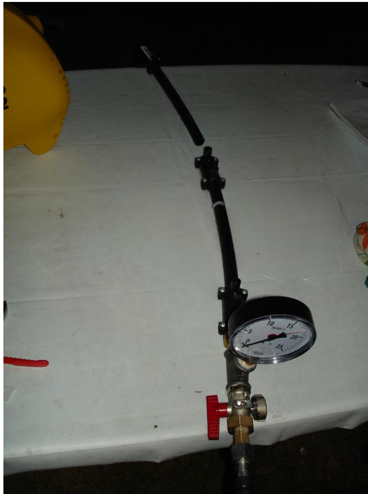
Slika 4.5. Ponovljeno tlačno ispitivanje uzorka br. 2. [13]
