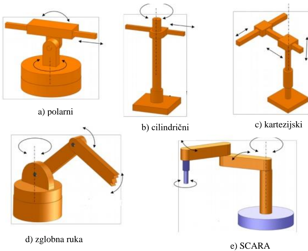
Slika 7.15. Osnovne konfiguracije robota prema zakretanju [13]
