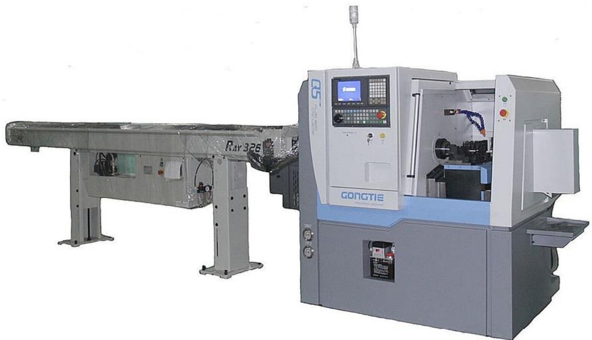
Slika 7.18. Automatsko vođenje šipke kroz glavno vreteno [16]
