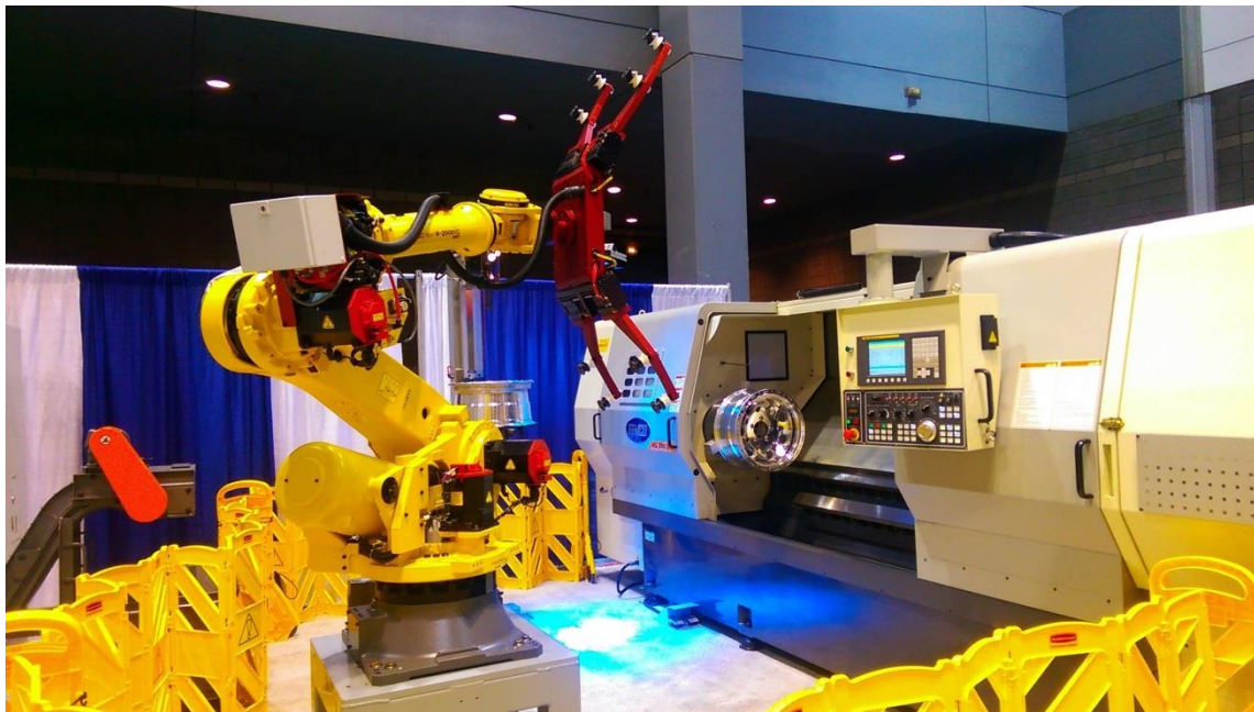
Slika 7.16. Robot posluhuje CNC tokarilicu [14]
