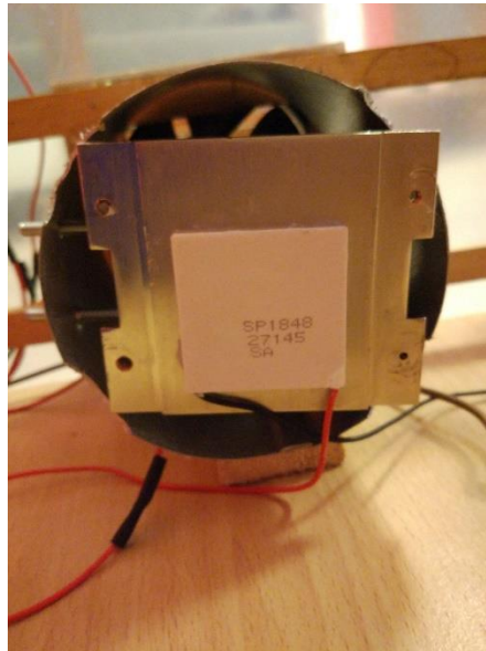
Slika 5.3 Peltierov element montiran na hladnjak te smješten u cijev
