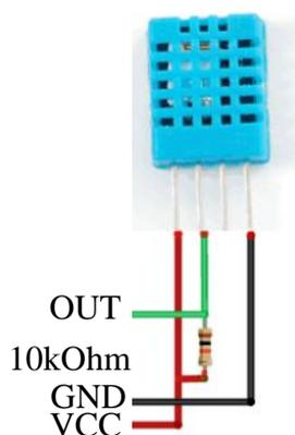
Slika 2.5.1. Shema spajanja DHTxx senzora
