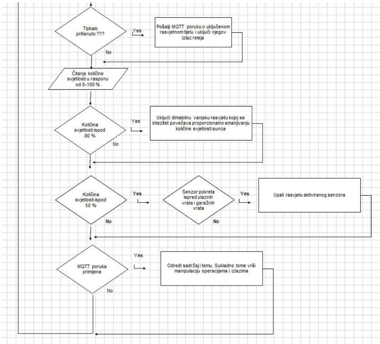
Slika 3.2.4 Pojednostavljena blok shema tijekom programa mikroupravljača
