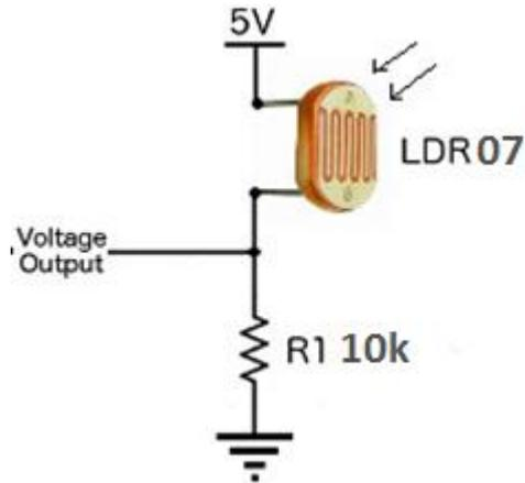
Slika 2.5.4 Shema spajanja fotootpornika [28]
