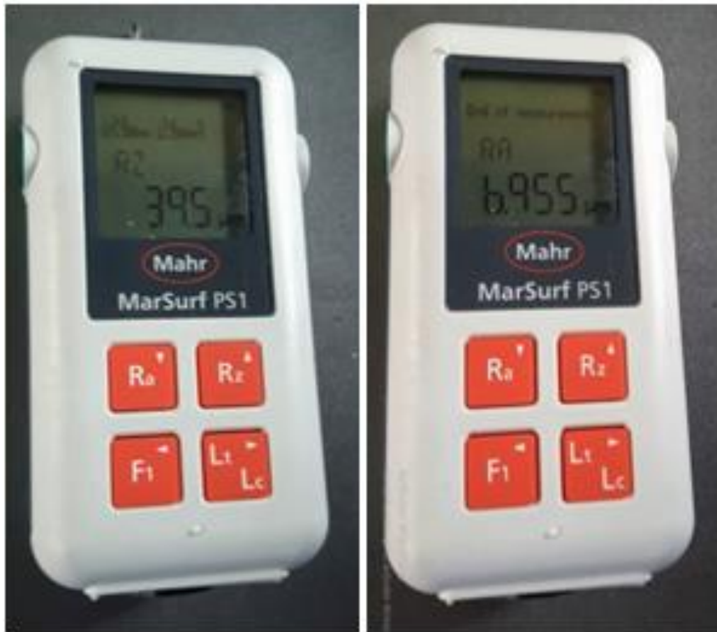
Slika 8.1.8 Rezultati mjerenja hrapavosti pjeskarenog lima mjernim uređajem
