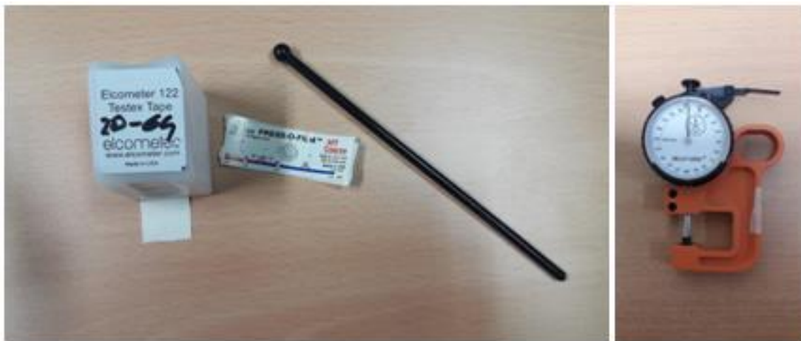
Slika 8.1.4 Oprema za mjerenje replika trakom
