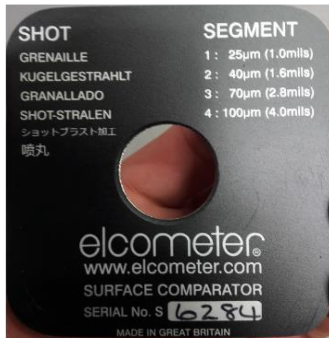
Slika 8.1.10 Vrijednosti hrapavosti za Shot (okruglu sačmu)
