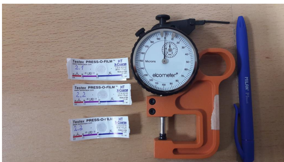
Slika 8.1.17 Tri otisnuta uzorka hrapavosti i mjerenje mikrometrom
