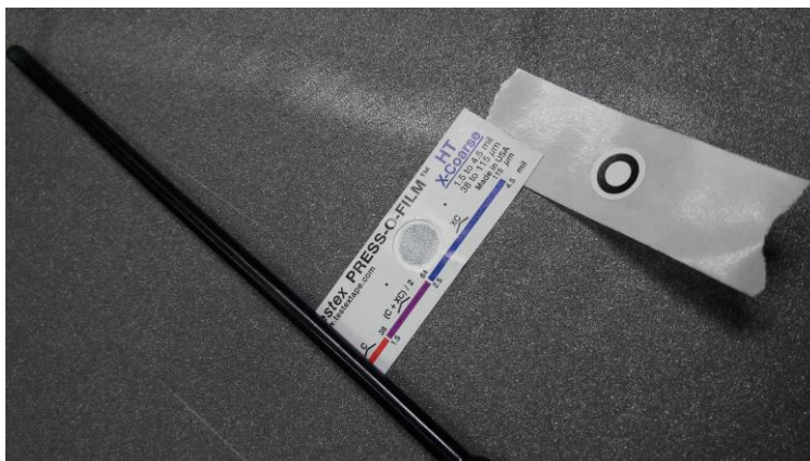
Slika 8.1.11 Mjerenje testex trakicom na poklopcu valovitog kotla.
