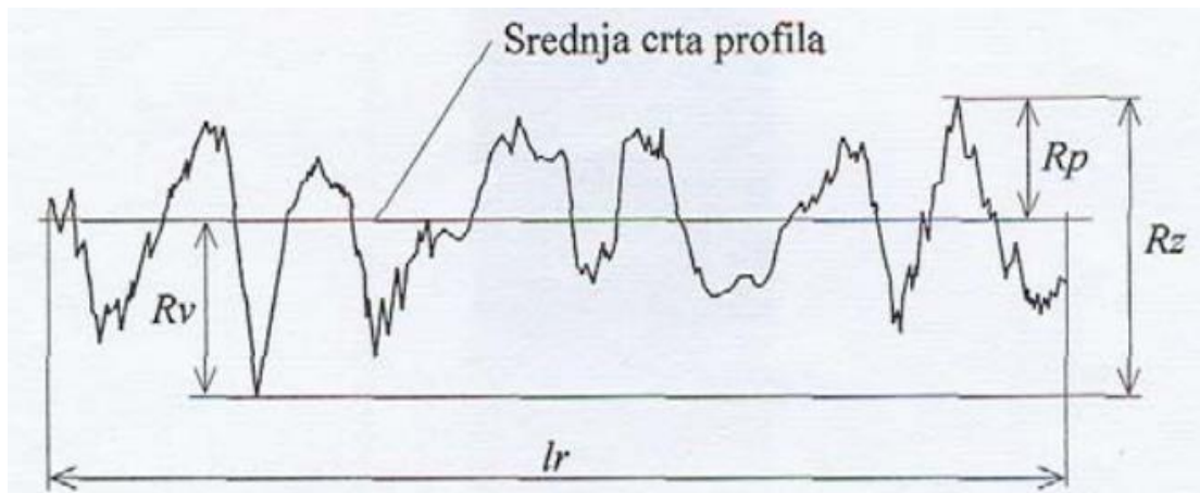
Slika 4.2.2 Prikaz odnosa R_z , R_p i R_v [6]
