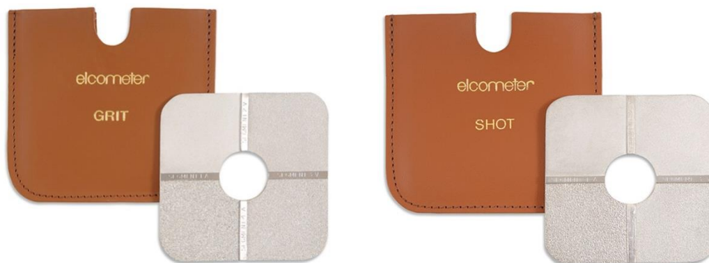
Slika 7.1.1 Komparatori: lijevo "Grit" komparator, desno "Shot" komparator [5]
