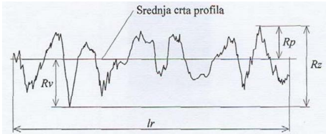
Slika 4.2.2 Prikaz odnosa R_z , R_p i R_v [6]
