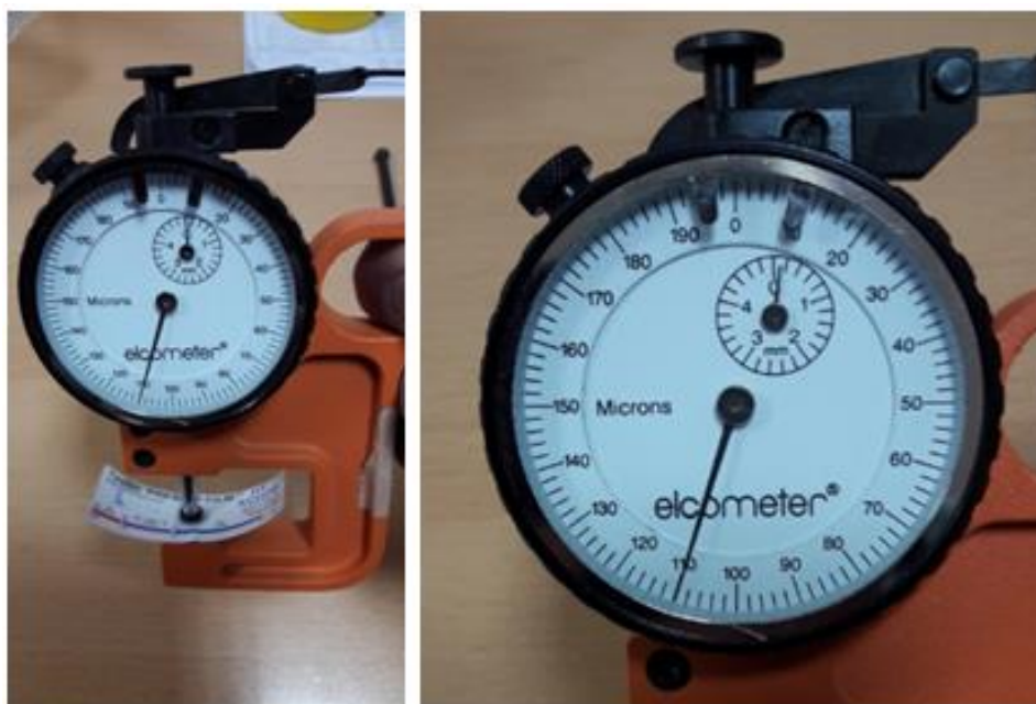
Slika 8.1.12 Prikaz rezultata mjerenjem debljine otiska pomoću mikrometra
