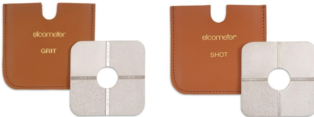
Slika 7.1.1 Komparatori: lijevo "Grit" komparator, desno "Shot" komparator [5]
