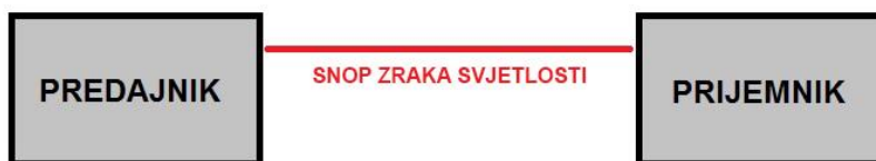
Slika 3.4 Dijelovi optičkog senzora
