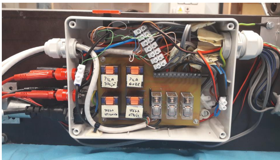
Slika 4.9 Razvodna kutija – otvorena
