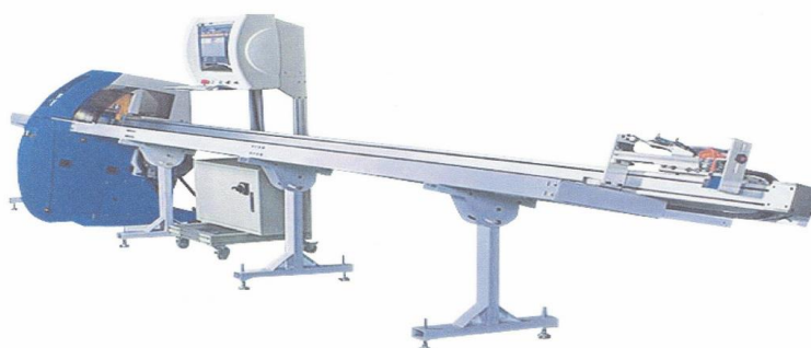
Slika 2.2 Automatizirana kružna preklopna pila s listom pile ispod materijala [2]
