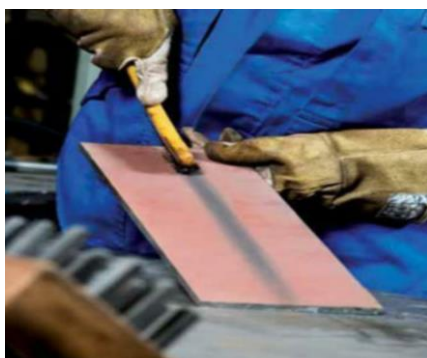
Slika 4.2 Skidanje zaštitnog sloja sa Strenx čelika [19]
