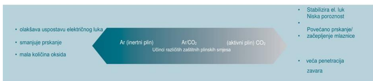
Slika 4.17 Učinci odabranog zaštitnog plina pri zavarivanju [18]
