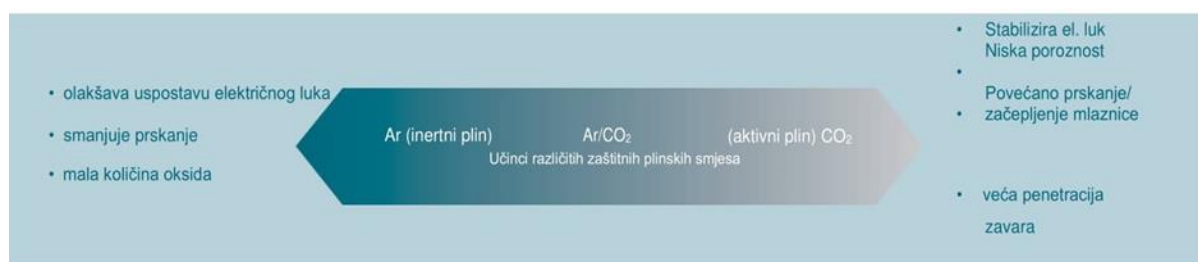
Slika 4.17 Učinci odabranog zaštitnog plina pri zavarivanju [18]
