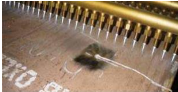
Slika 4.11 Automatsko predgrijavanje plinskim plamenom [19]
