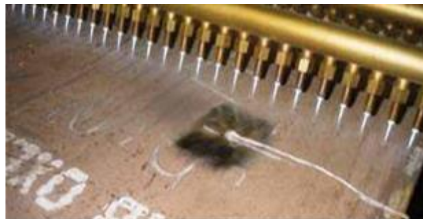
Slika 4.11 Automatsko predgrijavanje plinskim plamenom [19]
