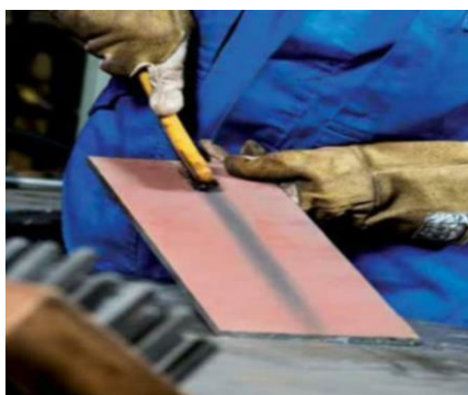
Slika 4.2 Skidanje zaštitnog sloja sa Strenx čelika [19]
