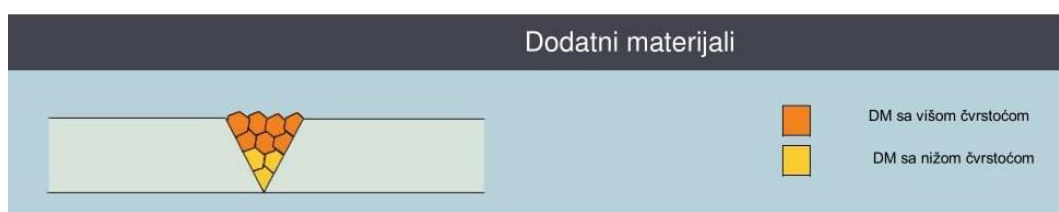
Slika 4.16 Korištenje različitih DM pri zavarivanju Strenx čelika [18]
