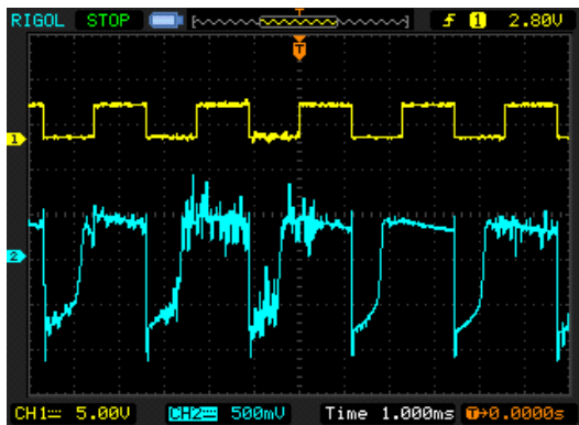
Slika 4.15. Ispravljanje pomoću ispravljačke cijevi
