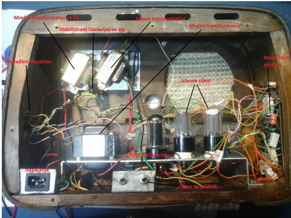
Slika 3.4. Ugrađeni segmenti pojačala u kutiju
