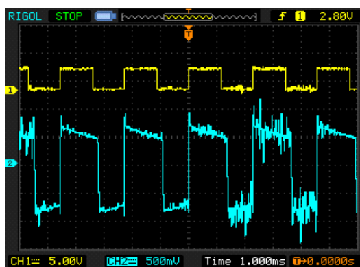
Slika 4.10. Ispravljanje pomoću dioda
