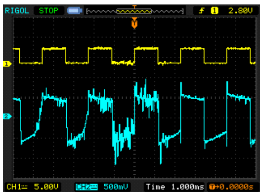
Slika 4.17. Kontrole equalizera su na 0%
