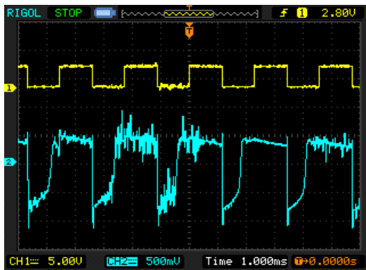
Slika 4.15. Ispravljanje pomoću ispravljačke cijevi
