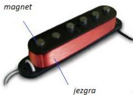
Slika 2.2. Izgled magneta gitare, engl. "Pickup"[3]
